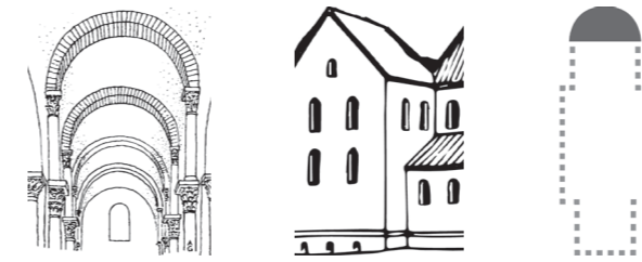
Figur 2.03 Hvelv med rundbuer, avtrappede vinduer, og grunnplan av kirkebygg med apsis. Etter Gunnarsjaa (1999)
