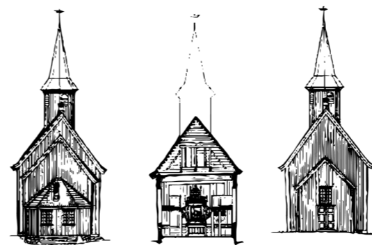
Figur 2.18 Hovin kirke, tverrsnitt og fasade. Sakristiet ses til venstre. Etter Christie og Christie (1959)
