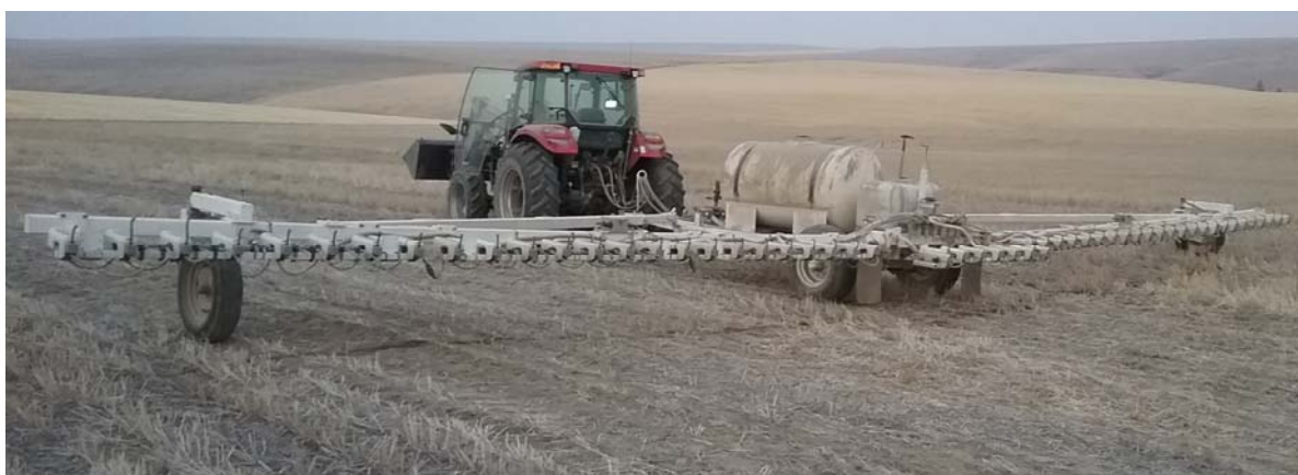
Figur 16. Kommersiell system for presisjonssprøyting av glyphosat på bl.a. kornareal. Øverst: Prinsippskisse for hvordan de sensor-baserte presisjonssprøytingsteknologiene WEEDit og WeedSeeker virker. Pil=kjøreretning; S=sensor; D=dyse. A: Sensor detekterer grønn plante. B: Dyse åpner seg og sprøyter planten. Illustrasjon: Therese W. Berge. Nederst: Tett i tett med WeedSeeker -enheter på åkersprøyta til den amerikanske kornbonden Bill Jepsen som praktiserer direkteåing og presisjonssprøyting av glyphosat både i stående åker og etter tresking (Yorgey et al. 2016).
