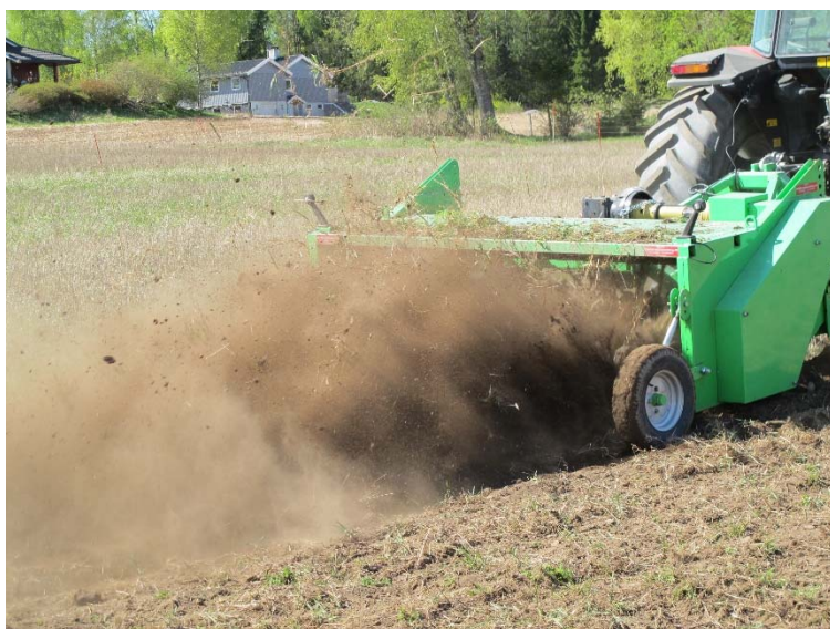
Figur 8. KVIK-UP-harv i bruk i forsøksfelt. Denne harvtypen har gåse-fotskjær i forkant (ca. 15 cm arbeidsdybde) for å løsne jorda, bakenfor er det en PTO-drevet aksling med fjærende tinder (ca. 5-7 cm arbeidsdybde) som legger jordstengler og røtter på jordoverflaten. Røtter og jordstengler bør ligge 4-5 dager i bra vær på overflaten før pløying og tillaging av såbed.
