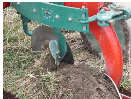
Figur 5. God kvalitet på pløyinga (se bilde til venstre), herunder best mulig bekjempelse av rotgraset, er blant annet relatert til plogens utrustning eksempelvis bruk av forplog (bildene til høyre).
