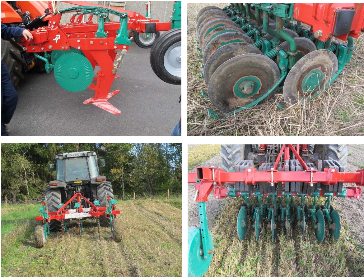
Figur 9. De to bildene til venstre viser prototyp av Kverneland horisontal-rotskjærer. Hvert av skjærene er litt over 50 cm brede og med noen cm overlapping blir hele arbeidsbredden gjennomskåret. Denne skjæreren ble primært laget for bekjempelse av åkertistel og andre arter med dypt rotsystem. Bildene til høyre viser Kverneland vertikal-rotskjærer, denne har rulleskjær på to akslinger og rulleskjærene lager ca. 10 cm dype slisser ned i jorda med 10 cm avstand mellom rulleskjær/slisser. Vertikalskjæreren ble primært laget for bekjempelse av grunt-voksende arter som kveke. De to skjærer-prototypene kan ha flere bruksområder men et særlig aktuelt bruksområde er stubbarbeiding på høsten med minimal bearbeidelse av jorda (Se de to nederste bildene)
