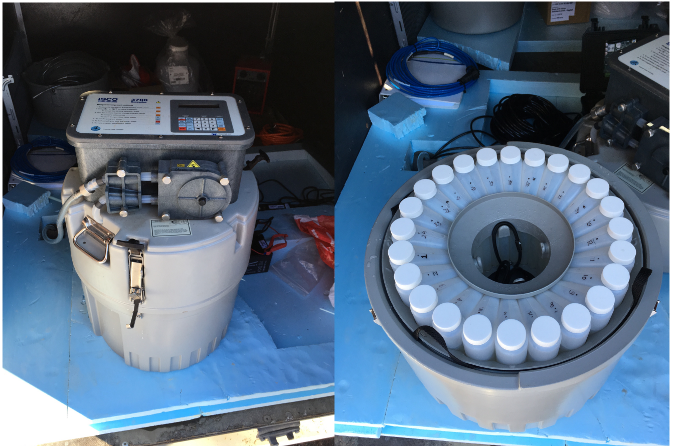
Figur 8: Prøvetakeren ”Isco 3700C Compact Portable Sampler”. Foto: H. K. Hafnor
