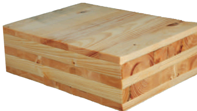
Figur 1 Krysslagte elementer med lim som forbindingsmiddel (Aarstad et al., 2008)
