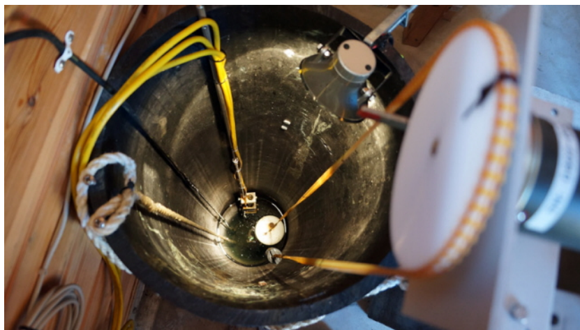
Figur 2.1: Bildet viser en flottørmåler sett ovenfra. Bildet er hentet fra https://www.kartverket.no/sehavniva/tidevann-og-vannstand/Slik-fungerer-vannstandsmalerne/
