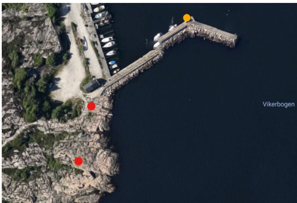
Figur 3.2: Bildet viser feltarbeidsområdet i Vikar, der innmålt TGBM/landsnettpunkt er markert i rødt og vannstandsmåler i gult.
