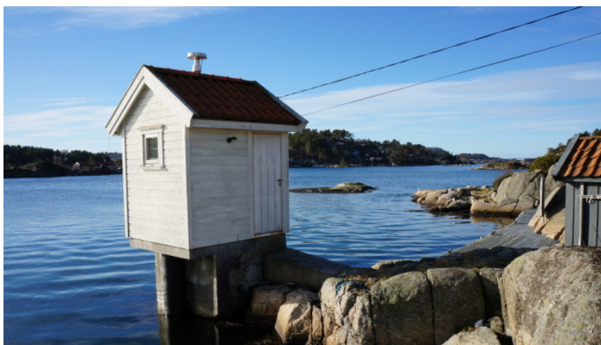
Figur 2.2: Bildet viser en typisk hytte hvor vannstandsmåler er plassert, hentet fra https://kartverket.no/sehavniva/Tidevann-og-vannstand/Hva-er-tidevann-og-vannstand/
