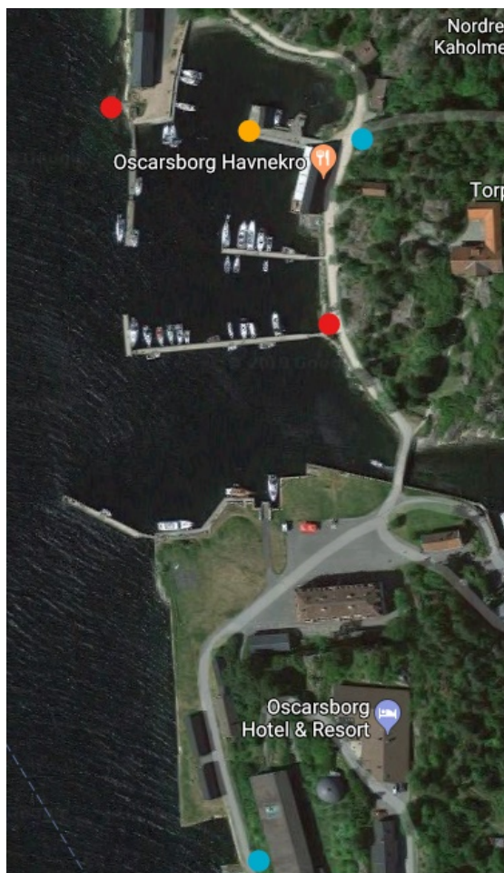
Figur 3.4: Bildet viser feltarbeidsområdet på Oscarsborg, der nyetablerte, innmålte bolter er vist i rødt, vannstandsmåler i gult og høydereferansepunkt i blått.
