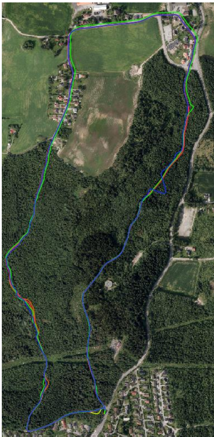
Figur 29: De seks beregnede linjene fra seks ulike målesesjoner med det IMU/GNSS kombinerte systemet med ortofoto som bakgrunn. Linjene fra hver målesesjon vises med hver sin farge.
