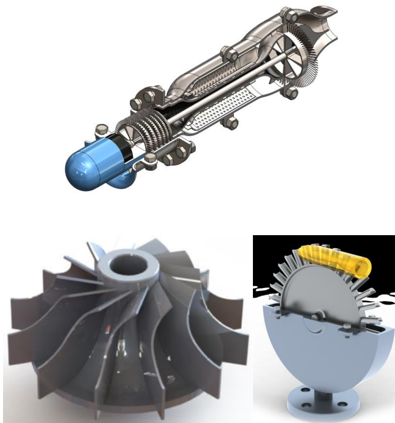
Figur 8: Ulike komponenter og systemer utviklet til Dolphin plattformen. Øverst: Multifuel gassturbin [15], NTV: Waste heat recovery system [16], NTH: Dampturbinløsning [17].
