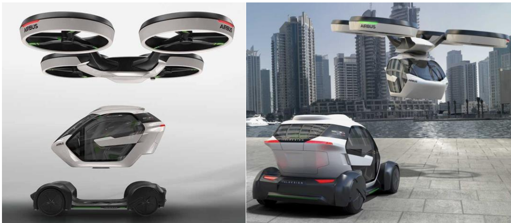
Figur 11: Airbus Pop.Up: til venstre; Modulene dronen består av, til høyre; Dronen i kjøremodus og i flymodus [22].
