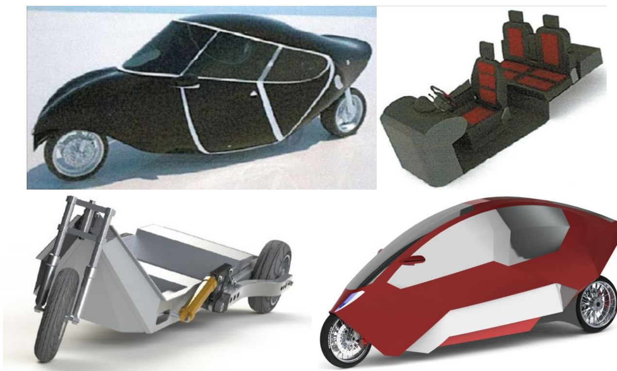
Figur 4: Resultat av forskjellige oppgaver utført på deltaversjonen av Dolphin Family: ØTV; Del A: Eksteriør [3], ØTH; Del B: Interiør [4], NTV; Del C: Ramme og hjuloppheng [5], NTH; Del D: Overchassis [6].
