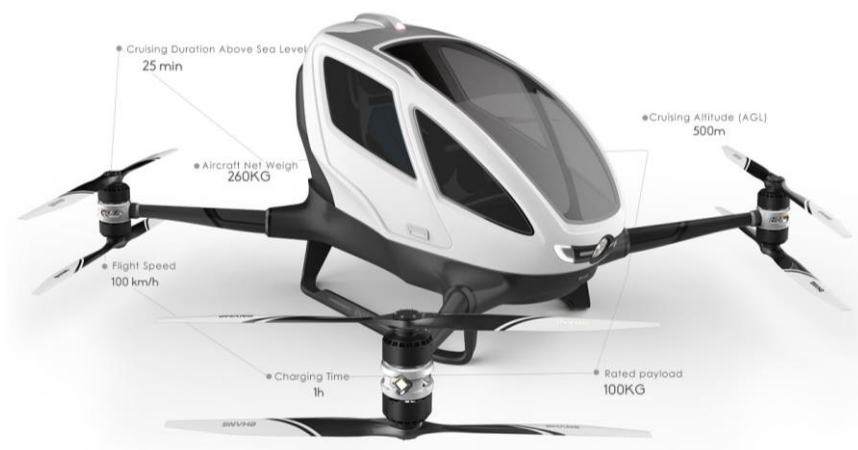
Figur 9: Ehang 184, med noen nøkkelspesifikasjoner [18].
