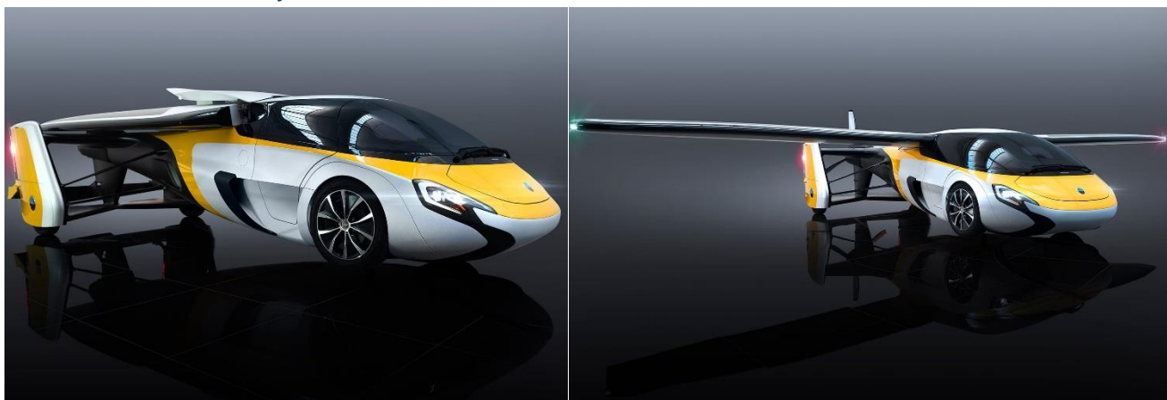
Figur 12: AeroMobil v4.0: til venstre; AeroMobil i kjøremodus, til høyre; AeroMobil i flymodus med vingene utfoldet [23].
