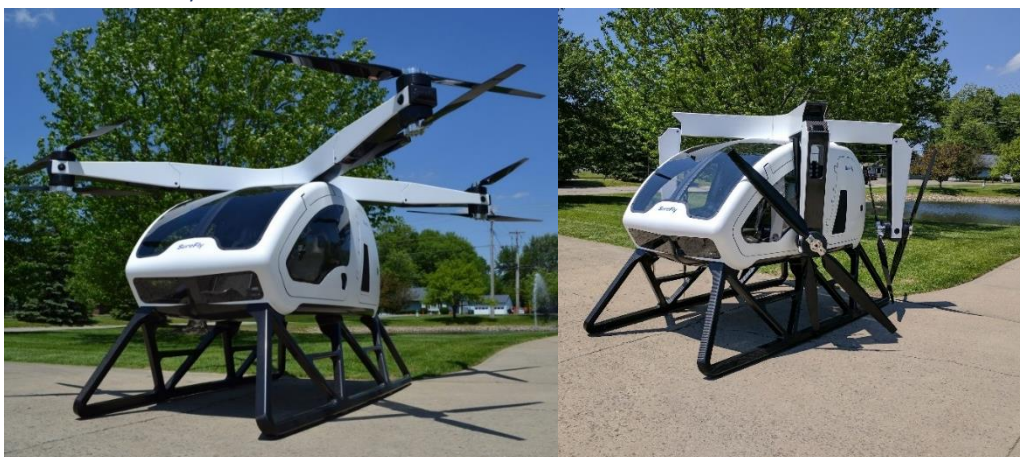
Figur 10: Workhorse SureFly: til venstre; dronen med motoropphengarmer utslått, til høyre; dronen med motoropphengarmer sammenslått [20].
