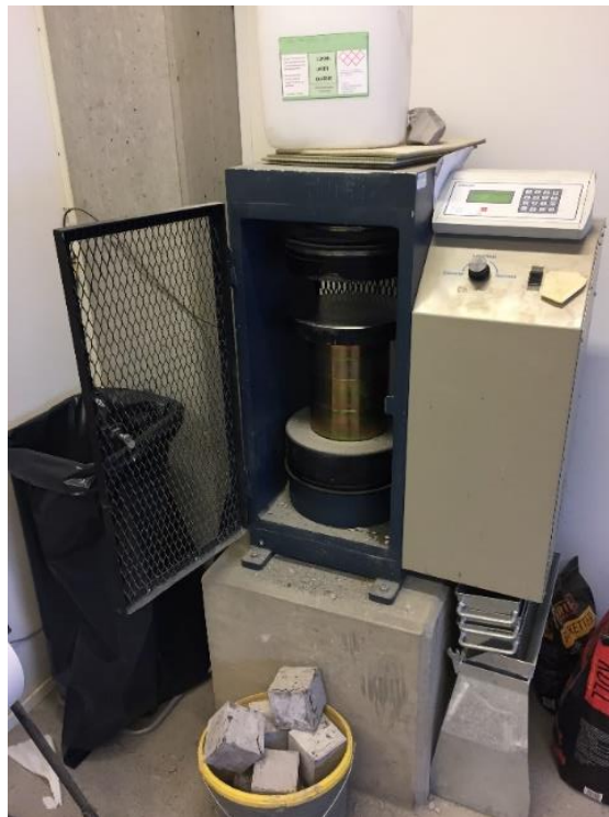
Bilde 16: Prøvingsmaskin for trykkfasthet.
