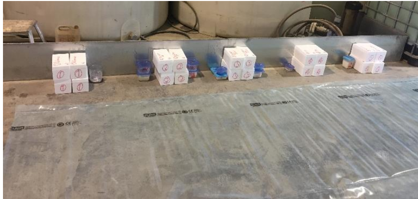
Bilde 24: Engangsformer og tilsetningsstoff klart til bruk.
