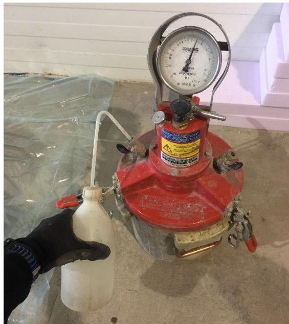
Bilde 10: Trykkmåler for måling av luftinnhold i betong.
