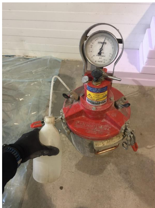
Bilde 25: Måling av luftinnhold i betongen.
