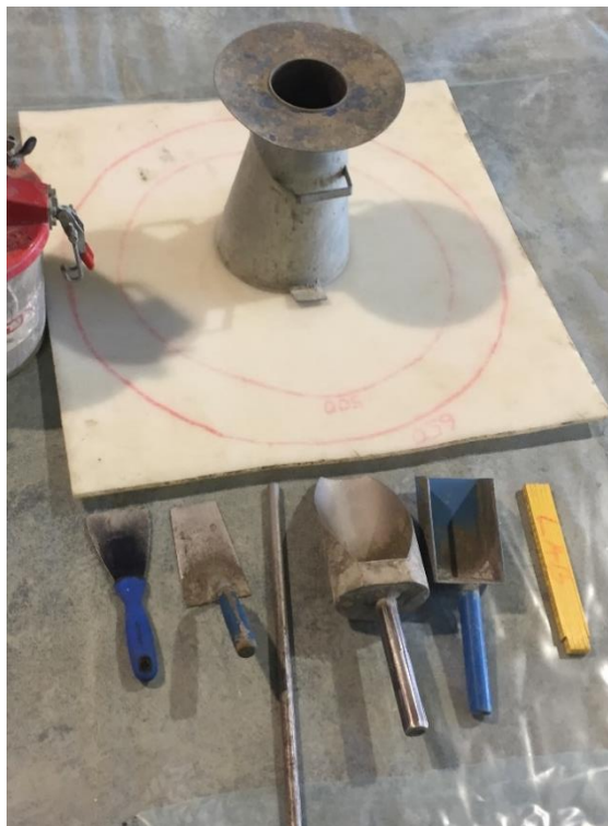
Bilde 11: Utstyr til testing av fersk betong.
