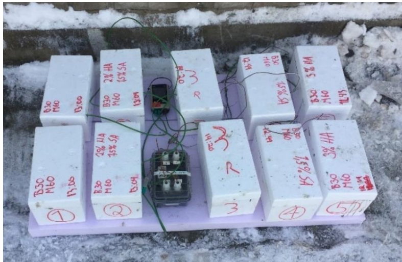
Bilde 15: Herding av terninger utendørs, med temperaturloggere.
