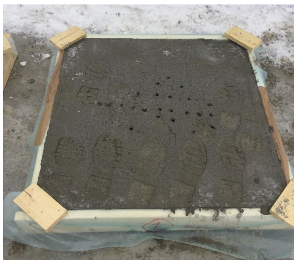
Bilde 22: Fotavtrykk og merker etter stakeprøver med bolt.
