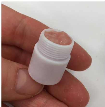
Figur 10. Teflonbeholder til NMR. Med brissel og uten skrulokk (Foto: Lise Gulliksen Schüller).
