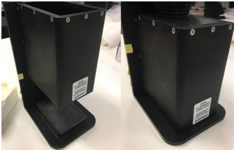
Figur 12. Sort kapsel som ble brukt til Raman-målingene for å forhindre strølys. Åpen til venstre og lukket til høyre (Foto: Lise Gulliksen Schüller).
