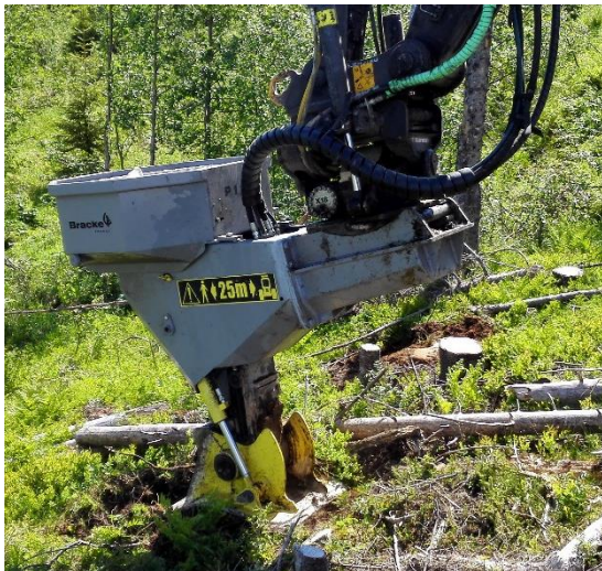
Figur 2: Brackeplanteren i ferd med å komprimere en invertert markberedningsfleck på flate 1 i forsøket.
