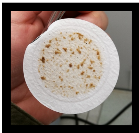
Figur 21. Filtrert prøve etter MBBR klar for tørking. Tydelige tegn på partikler og løsrevet biofilm.
