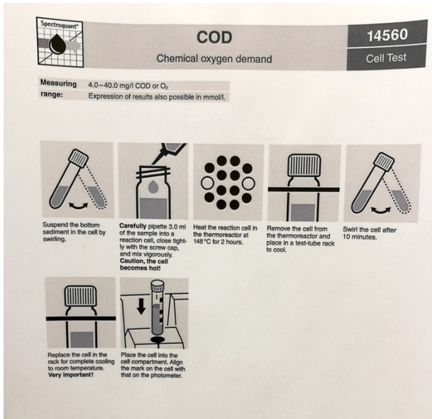
Figur 63. Fremgangsmåte for bruk av COD utstyr
