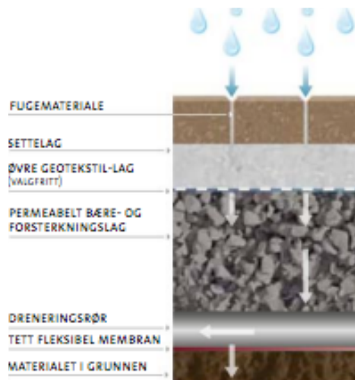
Figur 3-11: Prinsippskisse for delvis infiltrasjon i grunnen. (Lindholm et al. 2012)
