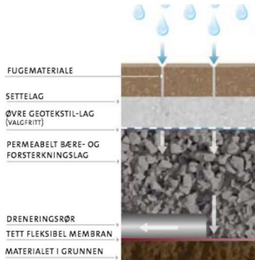
Figur 3-12: Prinsippsskisse for ingen infiltrasjon etablert med dretnrør (Lindholm et al. 2012).
