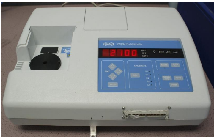
Figur B. 2: Turbidimeter Hack 2100N turbidimeter som ble benyttet i analyser av vannprøver (foto: LabX, 2018)
