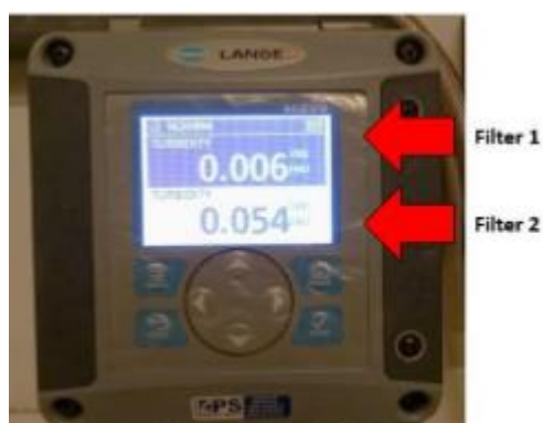
Figur C. 2: Online turbidimeter som ble benyttet i forsøkene (foto: Siren Skripeland).
