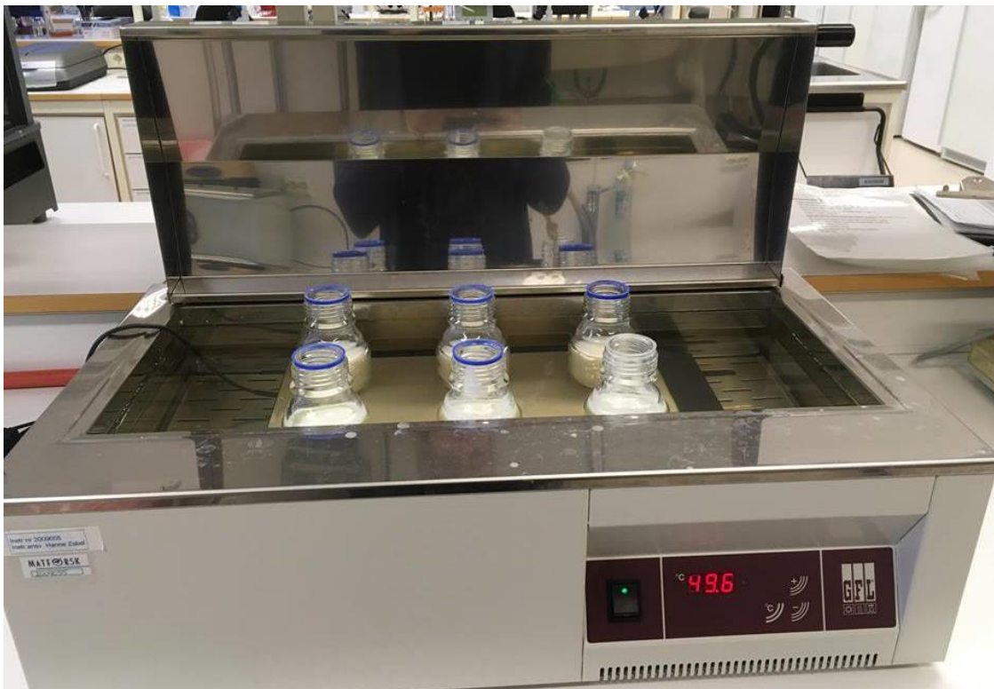
Figur 12: Oppsett for hydrolysene - I vannbad med magnetrører i bunn.
