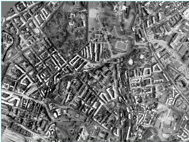
Figur 57: Scores-bilde for PC2 med tilhørende ladningsplott. Det største bidraget fra PC2 kommer fra tak og bygninger (hvit). Her er det størst bidrag fra bølgelengdene 600 til 750 nm, og under 500 nm.
