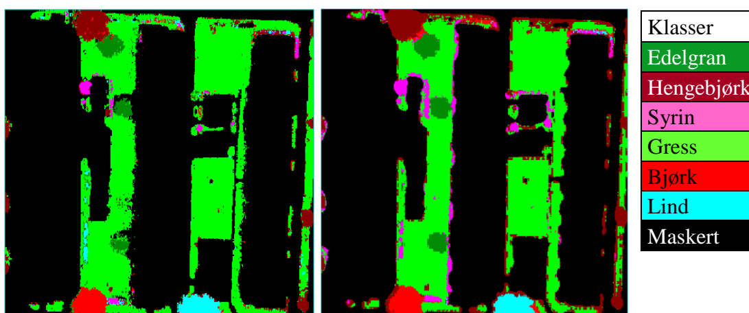
Figur 49: Visuell sammenligning av SVM på VNIR (venstre) og på VNIR+SWIR (høyre). Spesielt gress, edelgran og syrin er mer tydelig definert i bildet til høyre. Samtidig har hengebjørk og gress blitt forvekslet enkelte steder.
