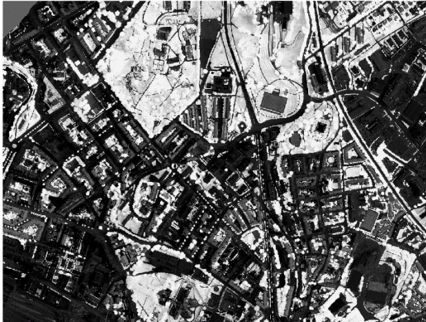
Figur 56: Score-bilde for PC1 med tilhørende ladningsplott. PC1 forklarer hele 92,59% av variasjonen i datasettet. Det største bidraget til denne komponenten kommer fra det nærinfrarøde området (700 nm til 900 nm). Størst variasjon er det mellom vegetasjon og områder uten vegetasjon.
