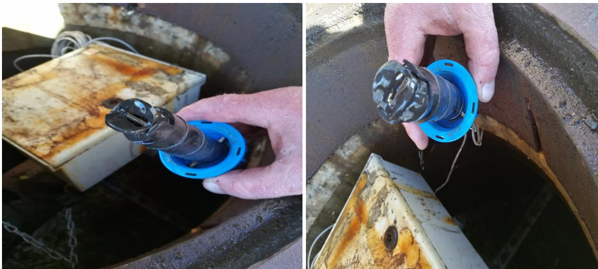
Figur 4.6: Nærbilde av sensoren den 6. april for kum syd. Akslingen på sensoren er dekket med et lite lag av partikler.
