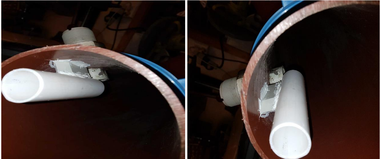
Figur 4.3: Bildet av påsatt rør for laminær strømming. Røret er plassert foran propellen til sensoren (ITAS, 2018c).
