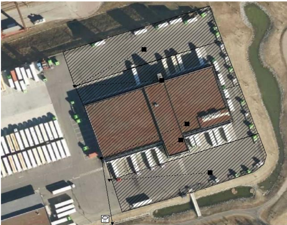
Figur 3.14: Skjermbilde av modellen i SWMM. De skraverte områdene representerer nedbørfeltene. Utløpene er vist i modellen som en trekant og nedbørmåleren er representert med et regnbygesymbol.
