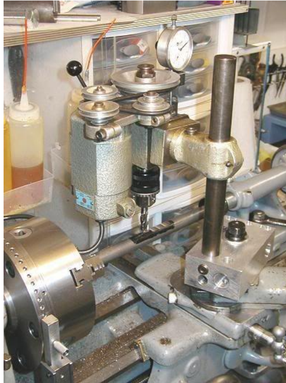
Figur 4.18: Vertikalt fresehode med elektromotordrevet reimdrift [22]
