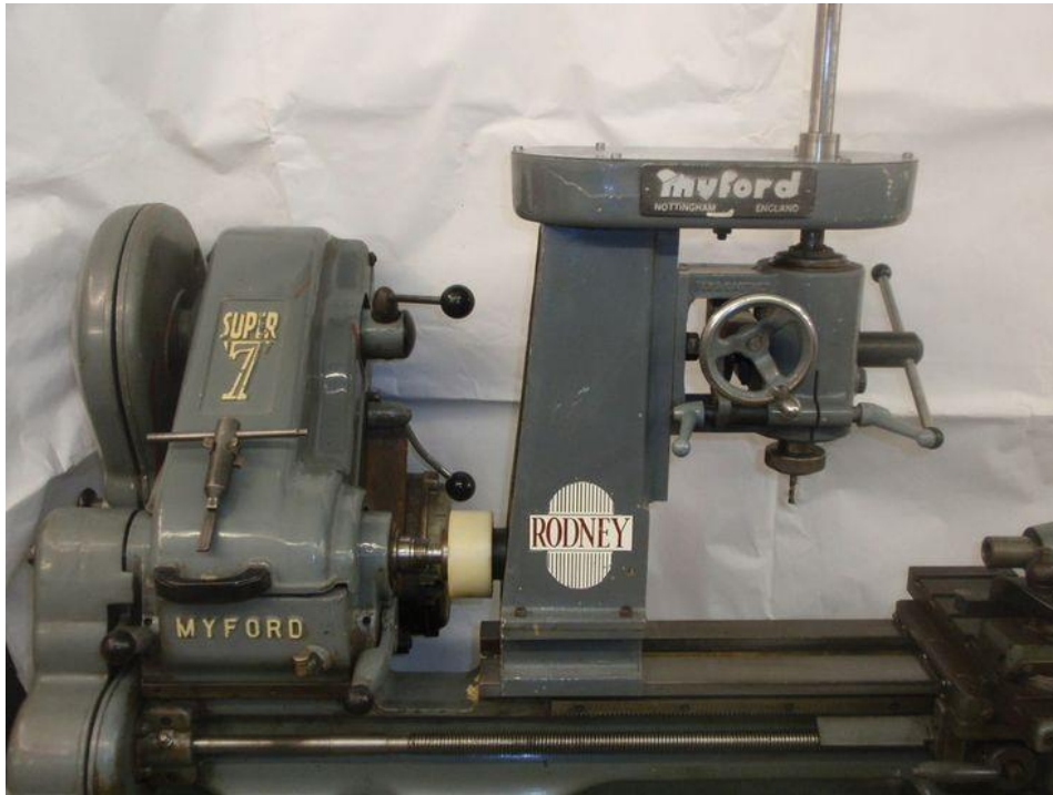
Figur 4.20: Vertikalt fresehode med direkte kjoksdrift [25].
