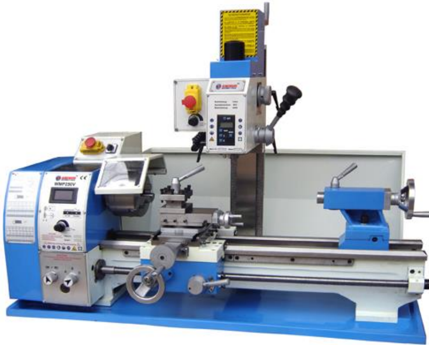
Figur 4.22: Kombinasjons-dreiebenk med fresehode på baksiden av maskinvange [9].
