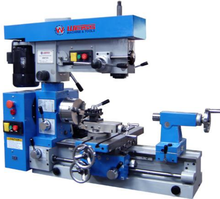
Figur 4.21: Kombinasjons-dreiebenk med fresehode på spindeldokke [9].
