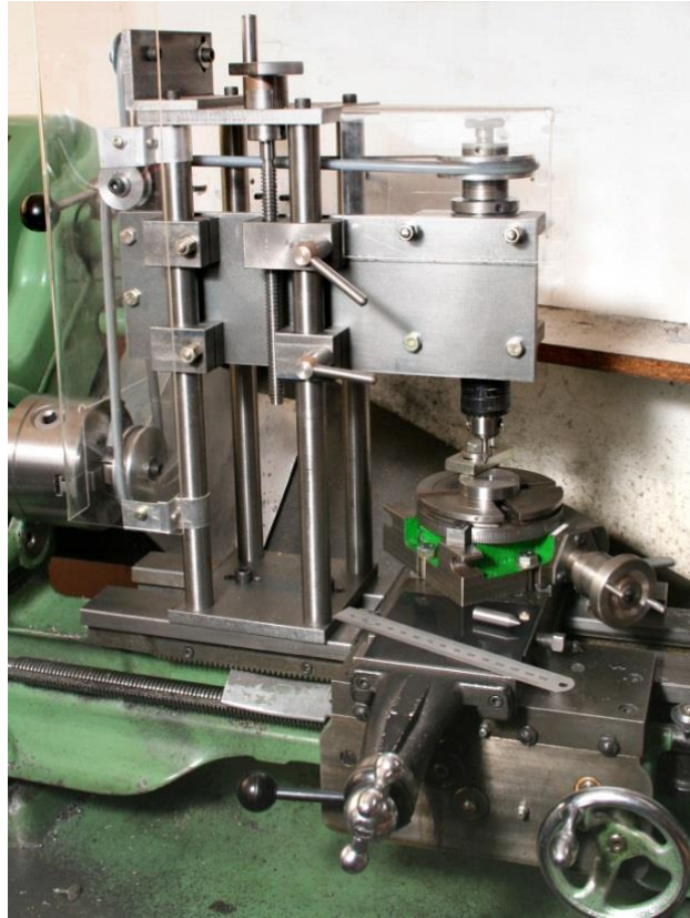
Figur 4.17: Fresing med vertikalt freshode med kjoksdrevet reimdrift [21]
