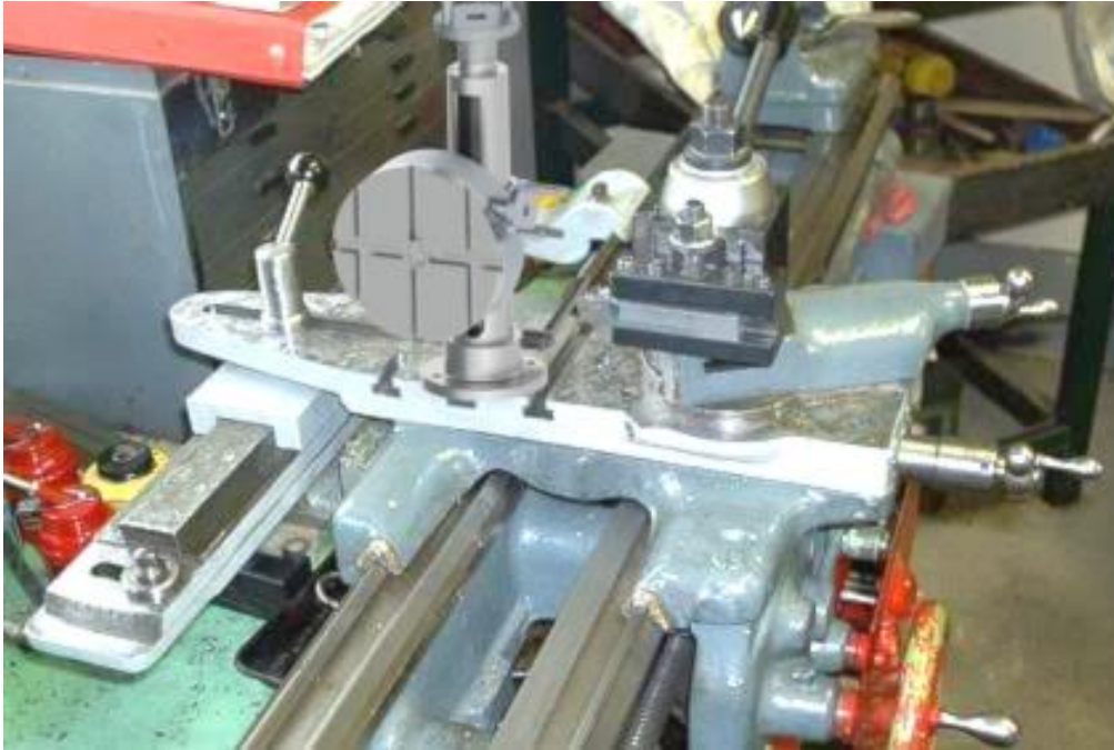
Figur 14.6: Fresemekanismen sett forfra, montert på tverrsleid med maskinbord-spor [69].
