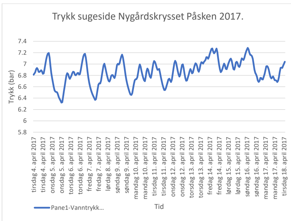
Figur 19. Trykkforhold sugeside uten innlagt økt forbruk Nygårdskrysset data hentet fra Epanet over 7-dagers simulering.
