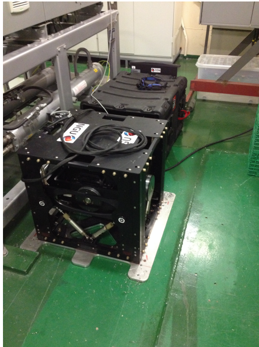
Figur 5.1: Bilde av gravimeterets montering i H.U.Sverdrup. IMUen står plassert rett utenfor høyre bildekant. (Foto: NGU)
