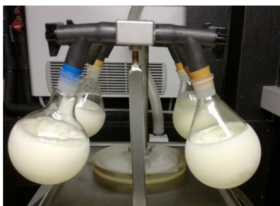
Figur 3 Rundkolber med konsentrat av sur myse under frysetørkeprosessen.
