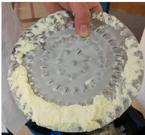
Figur 2 Resultatet etter forsøket på å tørke konsentrat av sur myse ved hjelp av spraytørke.
