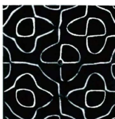
Figur 4.10: Piezoelektrisk effekt på stålplate med strøsand. (Bilde: [14])
