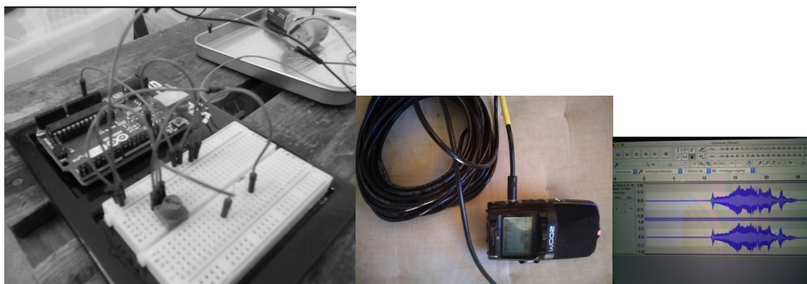
Figur 8.2: Fra venstre: Kontroll-enhet, error-inngang og referansesignal.
