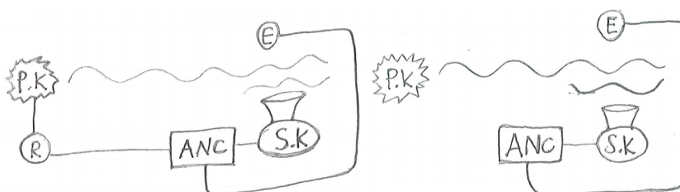
Figur 4.4 Til venstre: Foroverkoblet: Referansesignal (R) fra primærkilden (P.K) inngår i kontrollsystemet til sekundær kilde (S.K).
