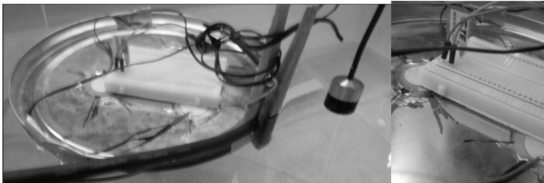
Figur 8.4: De tre piezo-elektriske kontakt-element på oversiden er inaktive, og et koblingsbrett er limt over med et akselerometer til referanse. Det var ønskelig å betrakte ulineariteter, men her ble det flere enn forventet. (Bilde: Eget foto)
