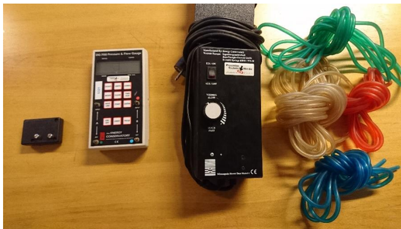
Figur 3.5 – WIFI sender, DG700, energikonservator og slanger i forskjellige farger.
