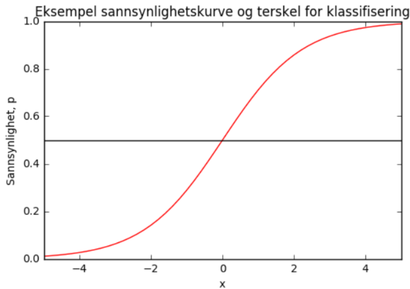
Figur 4.3: Eksempel på sannsynlighetskurve som kan brukes til klassifisering. Her er terskelen mellom to klasser satt til p = 0.5 .
