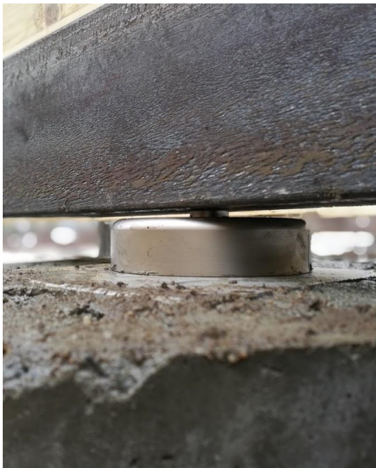
Figur 7.37 Veiecellen plassert mellom fundamentsøylen og hovedbjelken
