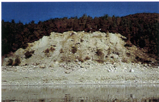
Bilde 3 Rasareal 4 (lengst syd) for tiltak, bildet er tatt høsten 1996 ved lavvann. Røtter av vegetasjon var undergravd øverst på feltet, det viste at undergravingen hadde fortsatt. Bildet tatt ved lav vannstand
