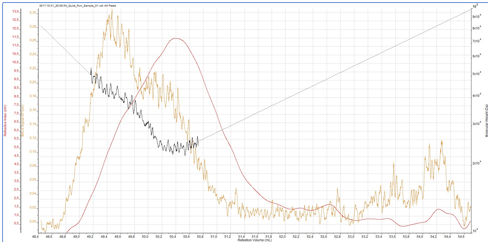
Figur 17. Viser brytningsindeks (rød), MALS-signal (gul) og molekylvektfordeling (svart) til ligninprøve med konsentrasjon 10 mg/mL dampeksplodert ved 180 °C 5 min.
