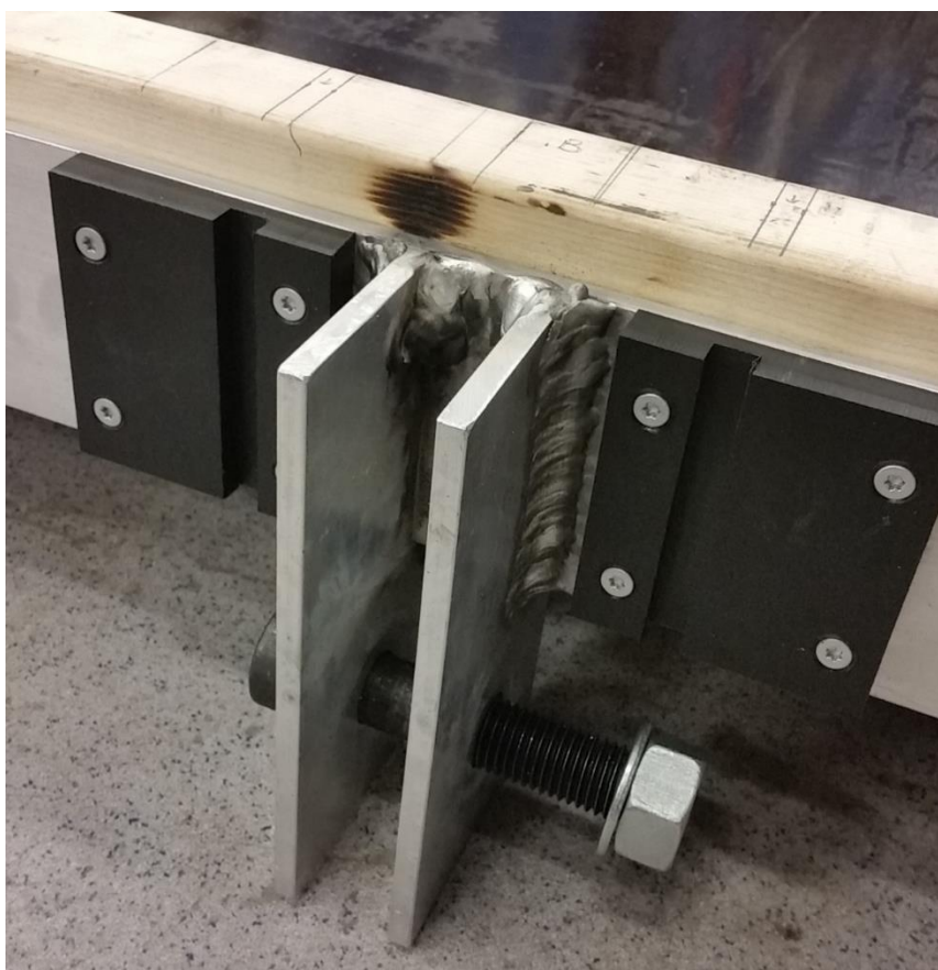
Figur 21: Viser påsveiset brakett til innfestning av lastceller og utskiftbare glideklosser for redusert friksjon mellom veggen og bunnprofilen. Bolten er 12.9 M24. Foto: Jan Are Jacobsen.
