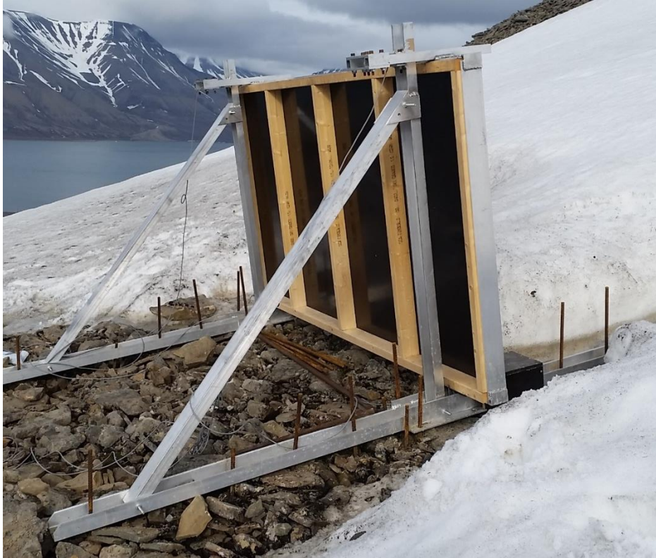
Figur 22: Forsøksvegg, med støtterammer forankret til bakken med armeringsjern og lastceller montert i strekk. Foto: Jan Are Jacobsen.
