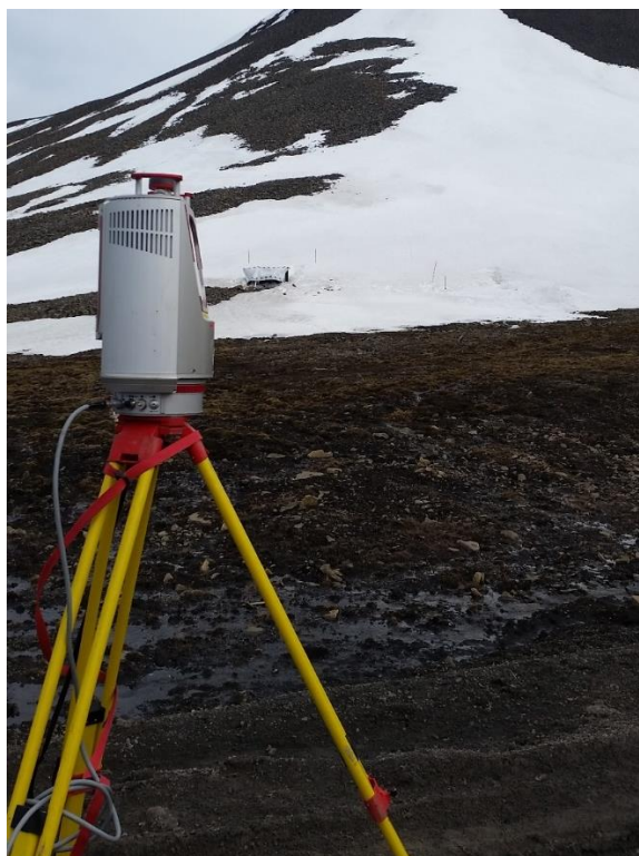
Figur 29: TLS under scanning av forsøksområdet, med forsøksvegg i bakgrunnen. Foto: Jan Are Jacobsen.
