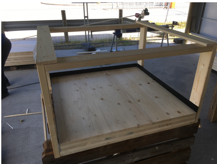
Figur 23: Bildet viser ramme for oppheng av element ved uttørkingsforsøket. Rammen hindret at elementene ble utsatt for trykk ved oppheng i veiecelle.
