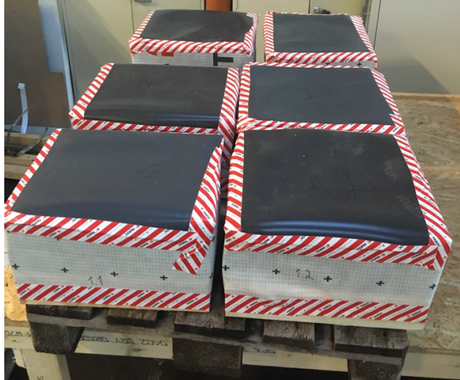
Figur 30: Ferdig oppsett av forsøk 2. Samtlige elementer er dekket med dampbrems på sidene, og PVC-folie på toppen for å hindre at fuktigheten avtar raskt.
