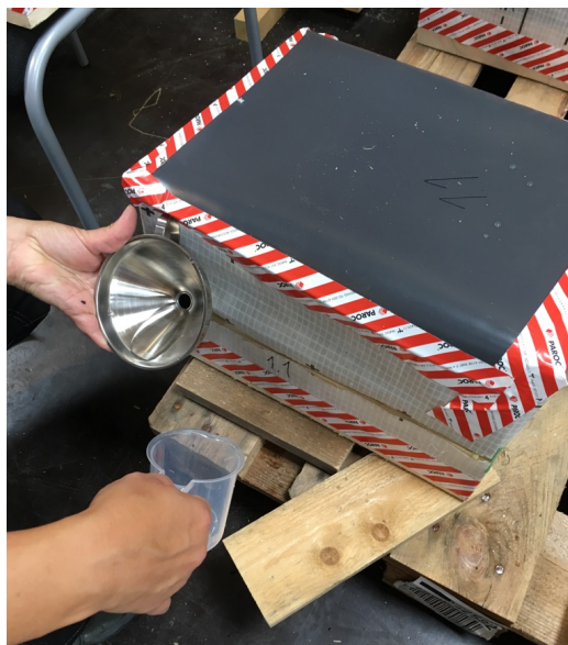
Figur 34: Etterfylling av sopp suspensjon. Plankebitene er lagt under for å gi en liten helning.
