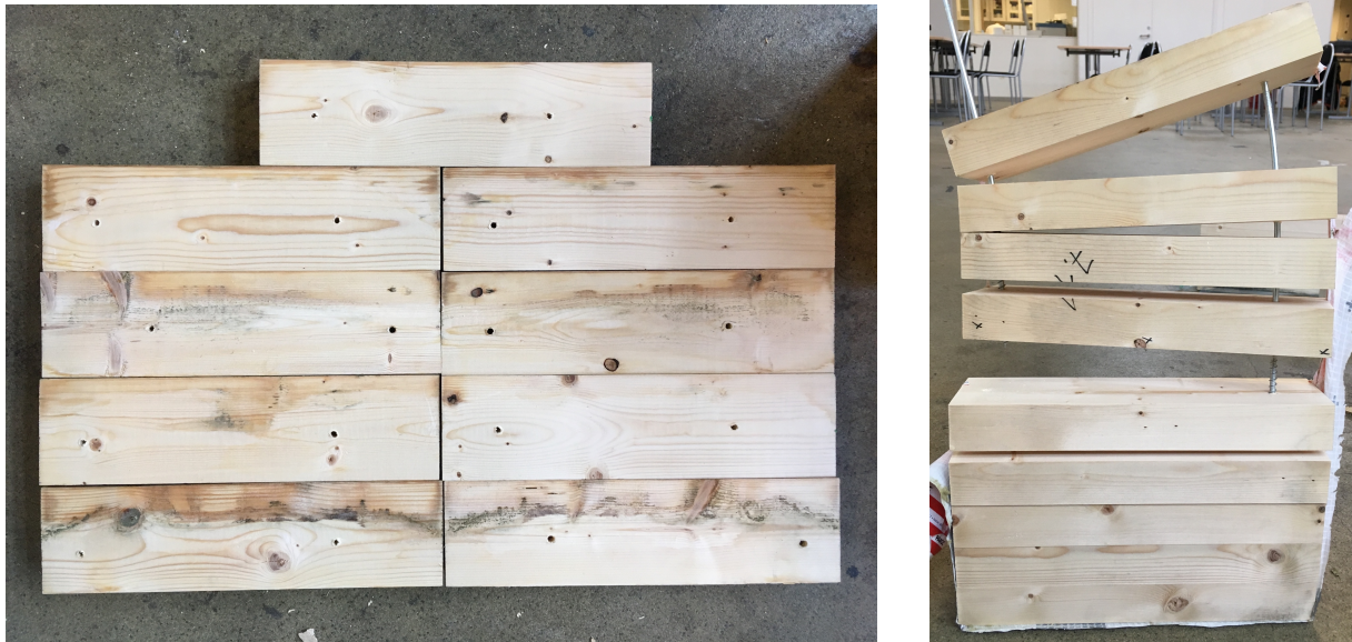
Figur 51: Lamellene skrudd fra hverandre for henholdsvis element 10.1 og 7.1
