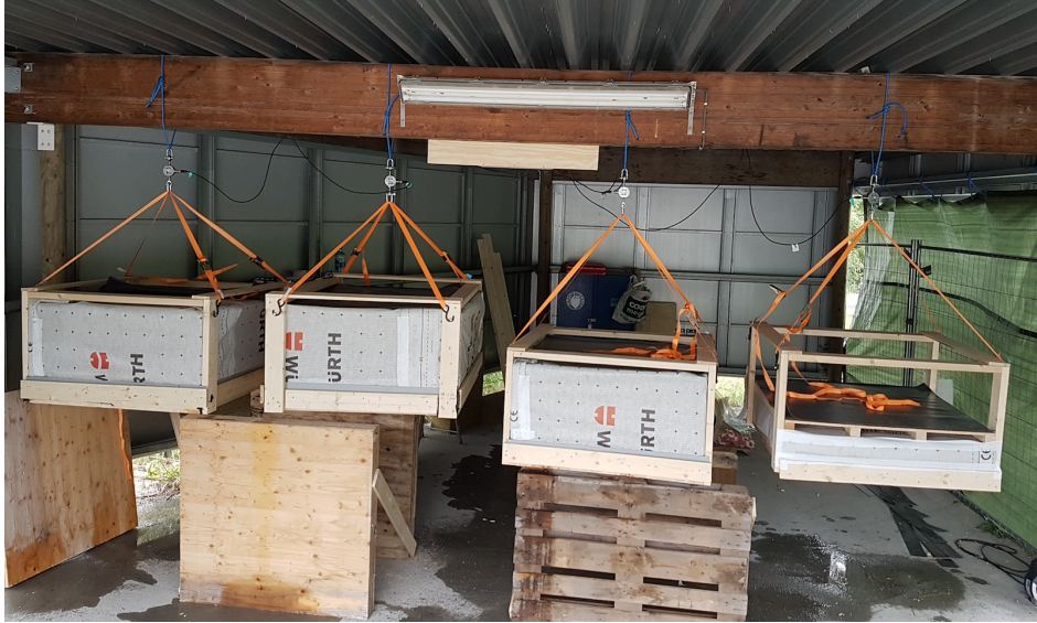
Figur 24: Oppsett og opphenging av uttørkingsforsøket. Elementene ble hengt opp i veieceller ved hjelp av jekkestropper.
