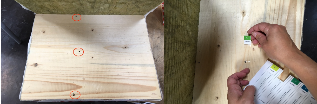
Figur 33: Metode for tapeavtrekk på overflaten til hvert prøveelement
