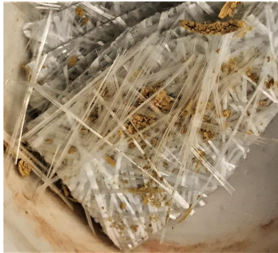
Figur 21 Gul kompositt etter brenntest
