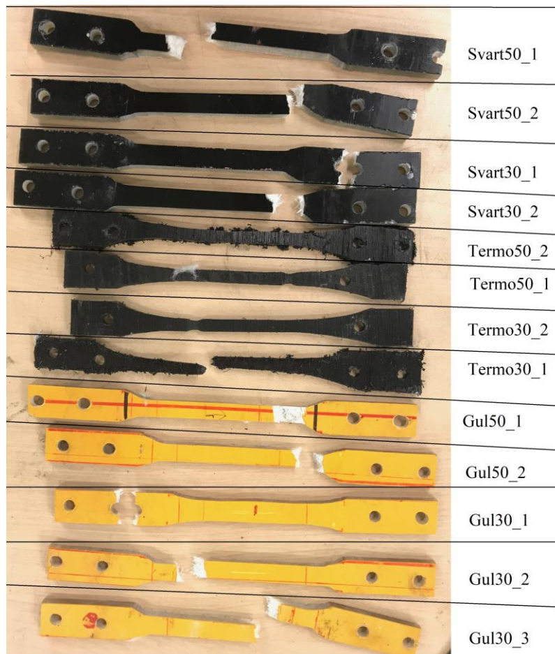
Figur 22 Alle prøvestavene etter at de har blitt testet.
