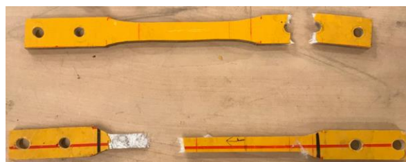
Figur 10 På det øverste teststykket har bruddet oppstått ved boltene. Brudd skal oppstå innenfor svarte linjer på nederste teststykket
