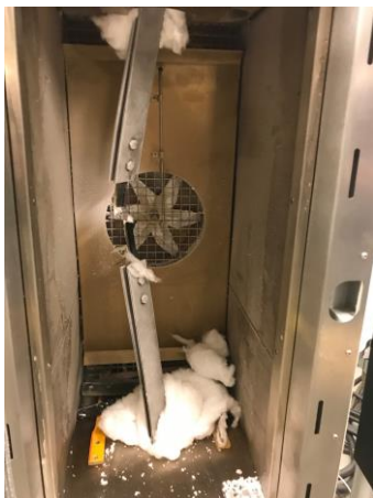
Figur 13 Bøyde skjøtestykker fra uhell
