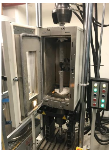
Figur 8 Kuldekammer med innfestet prøvestav festet til skjøtestykkene
