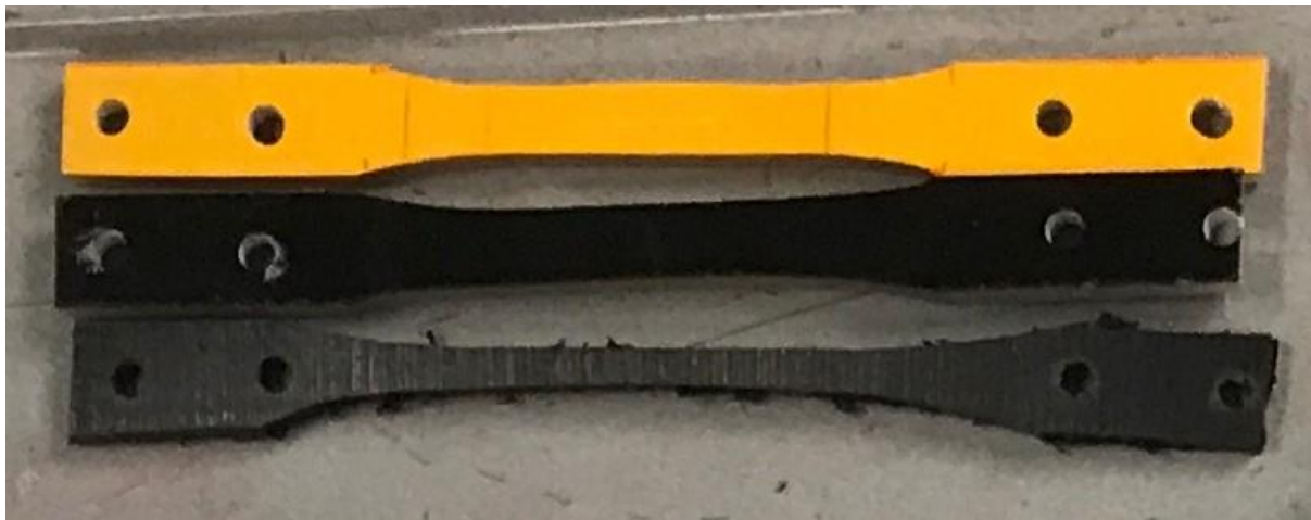
Figur 6 Bilde av de tre forskjellige teststykkene. Gul og svart kompositt øverst, mens termoplasten er nederst.
