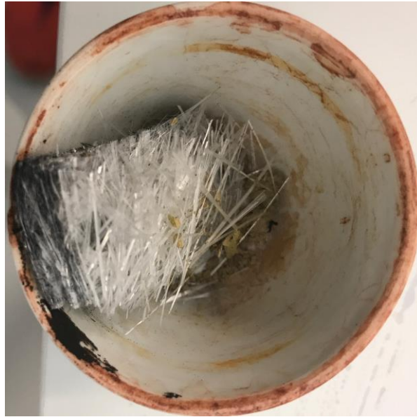
Figur 20 Svart kompositt etter brenntest
