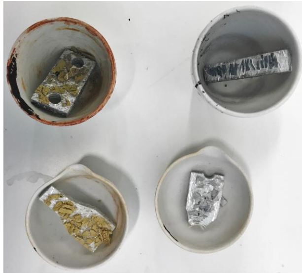
Figur 19 Eksemplarene etter fullført brenntest
