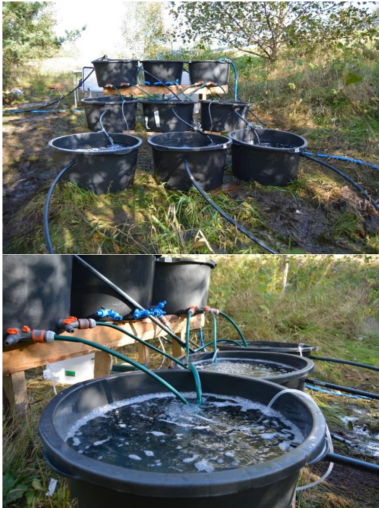
Figur 6. De tre øverste dunkene inneholder (fra venstre) vann direkte fra renseanlegg, vann fra Stordalsbekken og til høyre sjøvann fra fjorden. I midten er det blandekar, og nederst ferdige blanding med vann. Stordalsbekk 20ppt, renseanlegg 20ppt og renseanlegg 10ppt. (Foto: Hanne Johansen)
