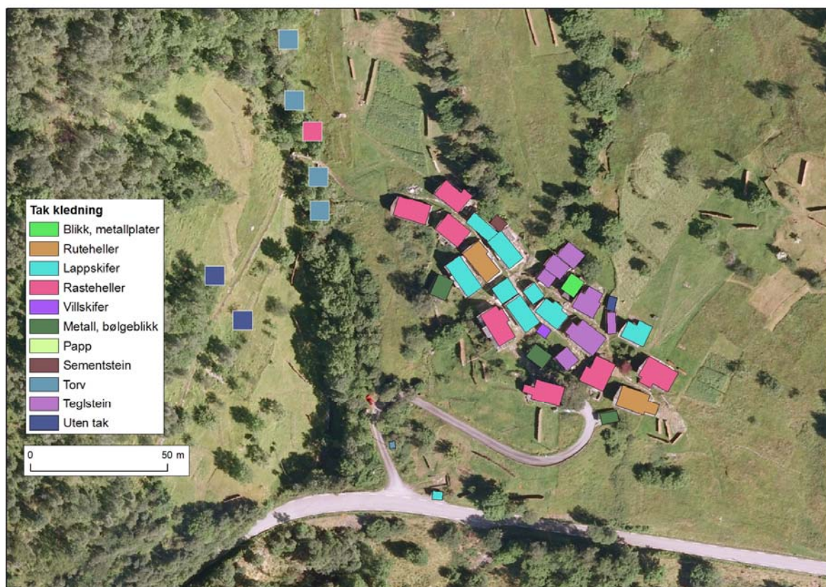
Figur 8. Eksempel på temakart over nedre del av Havrå kulturmiljø. Bygningene er kategorisert i henhold til takkledning, basert på feltregistrering.
