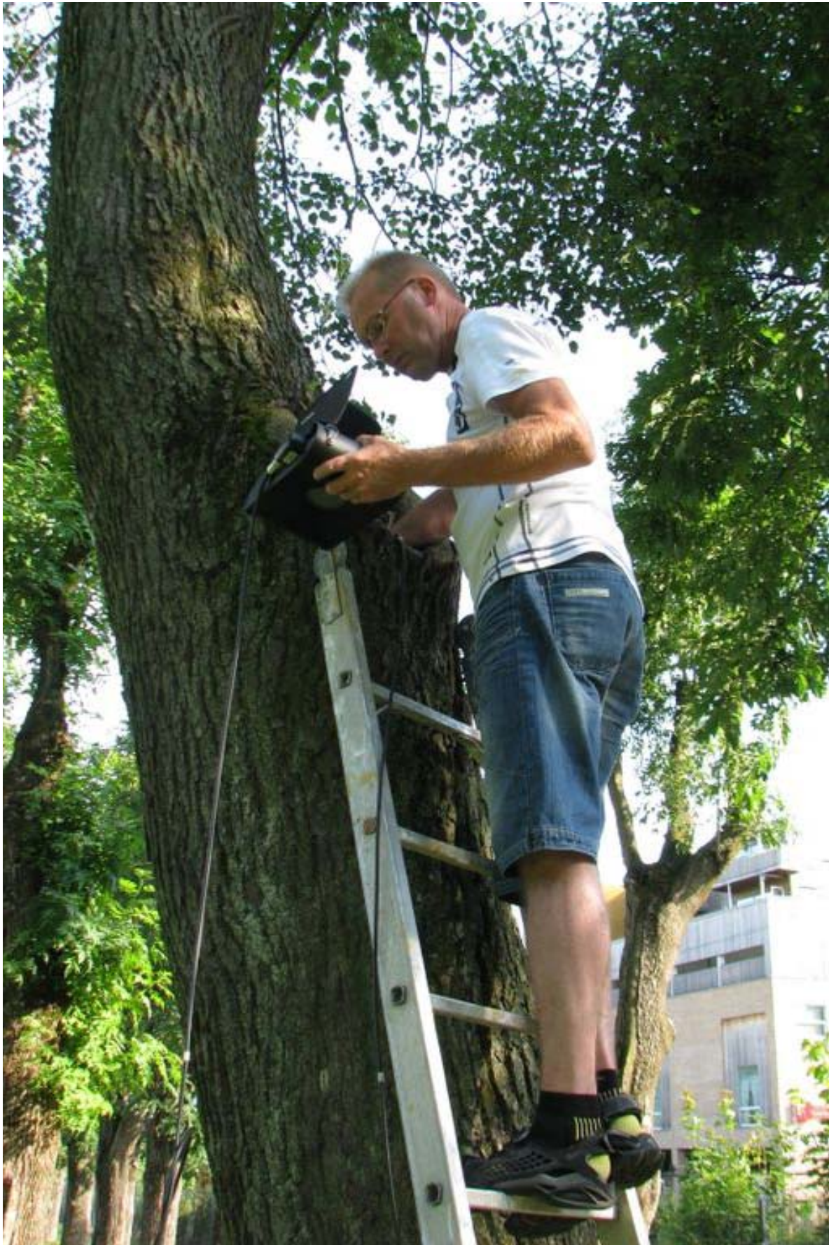
Figur 3. Bruk av feierkamera for å undersøke hulheter i trær. Foto: Magne Flåten.
