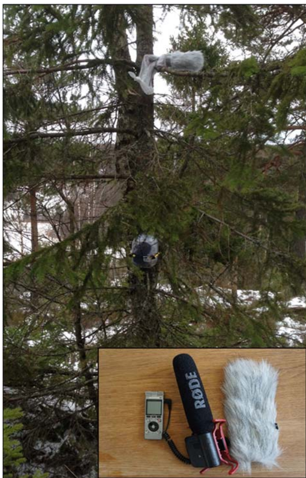
Figur 1. Opptakssett bestående av diktafon og ekstern mikrofon brukt til kartlegging av hønehauklokalteter.
