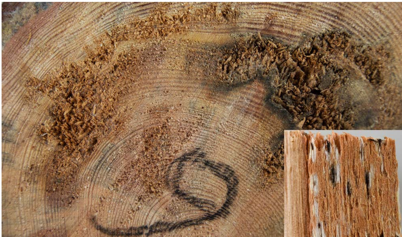
Figur 32. Råte forårsaket av fururotkjuka i furu fra Dovre. Stort bilde: Råteverrsnitt ved stubbehøyde. Innfelt: Karakteristiske svarte og hvite flekker. Foto: Halvor Solheim.
