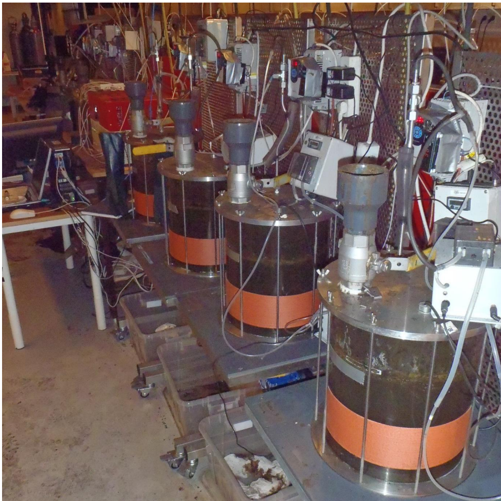
Figur 21. Forsøksreaktorar (CSTR reaktorar) med gasssteljar, varmebelte, og tilførringsrør.
