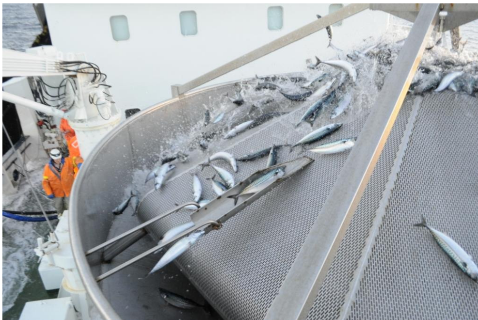
Bilde 1: Stikkrenne for uttak av sidestrøm for veiing av enkeltfisk under ombordtaking av pelagisk fisk.
