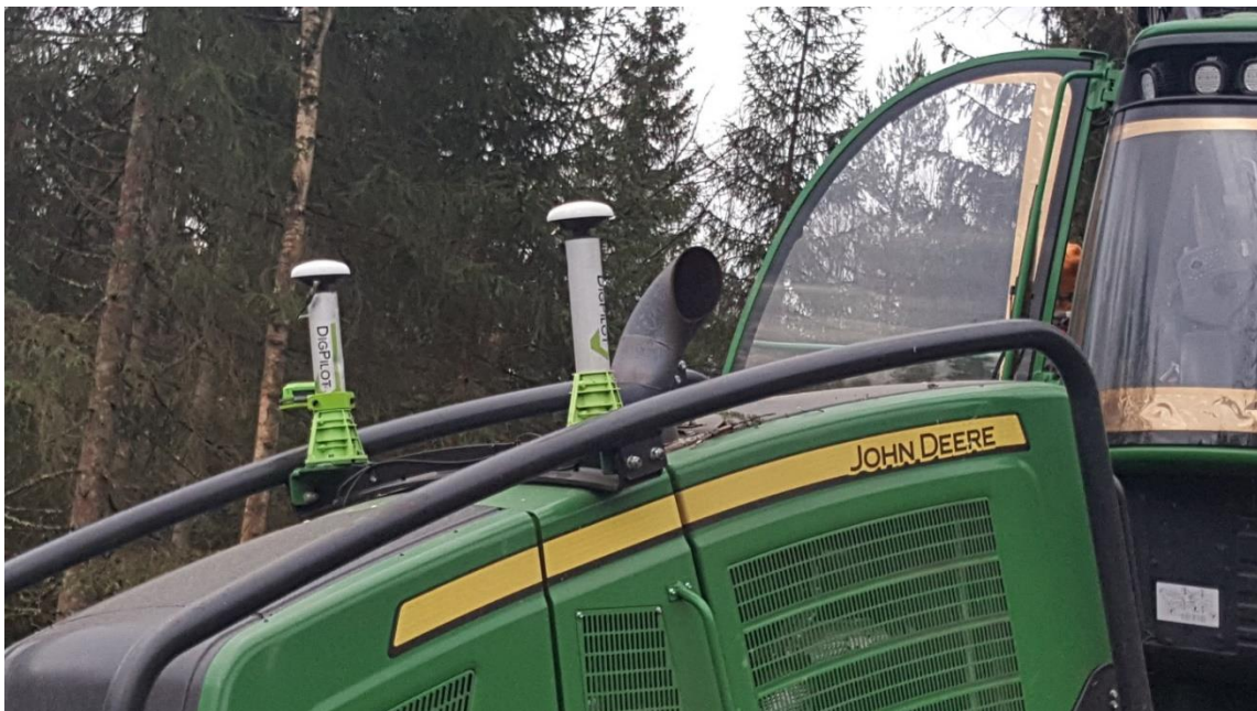
Figur 2: John Deere 1270E med ekstra GNSS antenner
