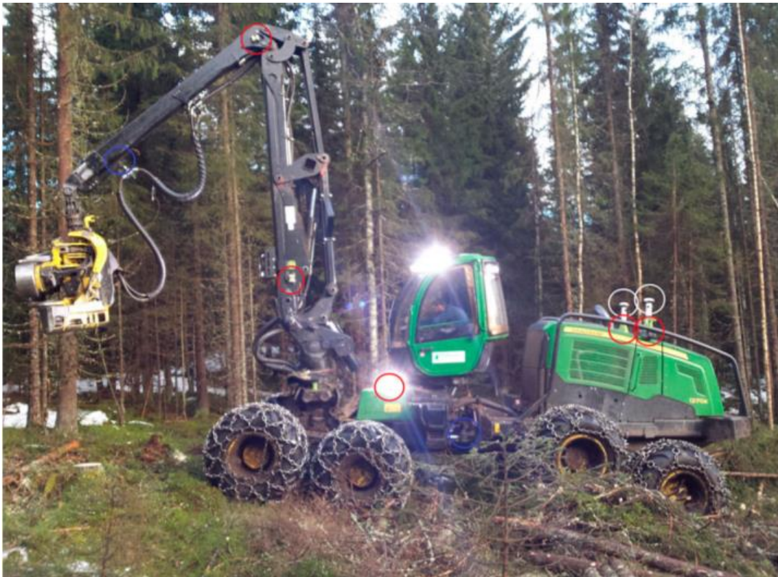
Figur 4: Plassering av sensorer montert på hogstmaskin, hvite sirkler viser GNSS antenner, blå ringer viser hydrauliske sylindere og røde ringer viser vinkelsensorer. Kilde: (Hauglin et al. 2017)
