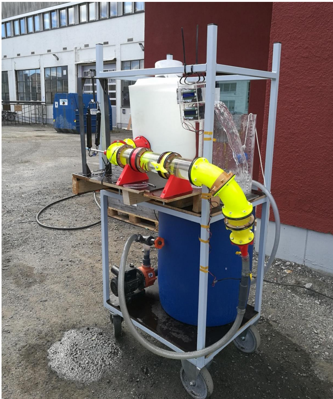
Figur 10-5. Testing av testrigg utendørs på NMBU sitt område. Testing med 6-bladet propell og påmontert vinkelmodul.
