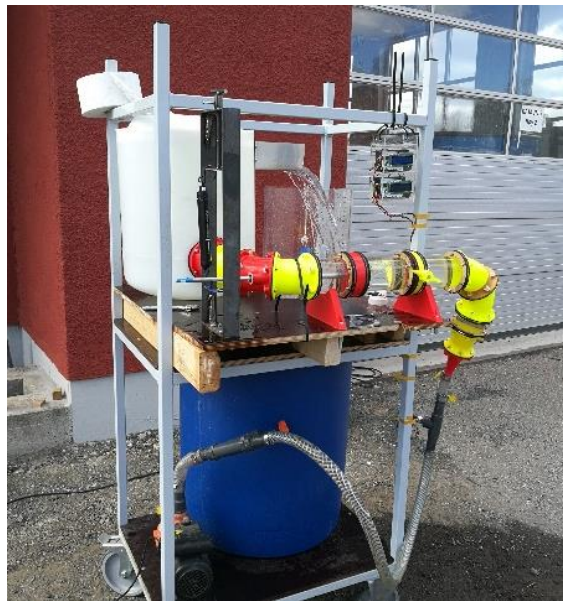
Figur 11-18. Testing av produkt med påmontert vinkelmodul. Det er tydelig at vannet renner fra buffertank til måletank.
