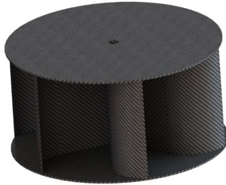
Figur 4-9. Skovhjul turbin som ble brukt i forprosjekt [1].
