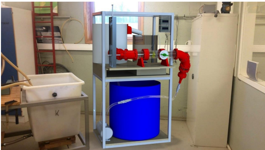
Figur 10-3. Testriggeren plassert på et av universitetets laboratorier med påmontert vinkelmodul.
