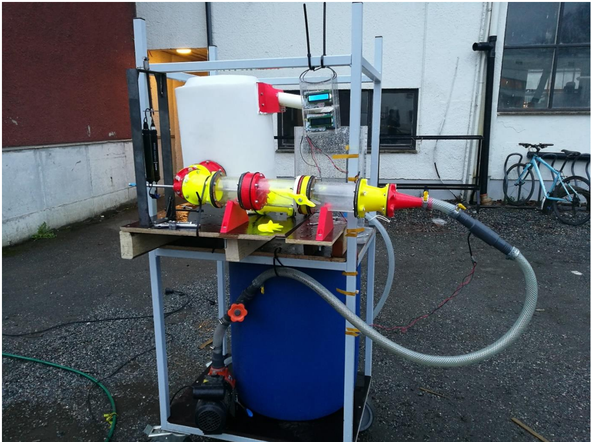
Figur 10-6. Testing av testrigg utendørs på NMBU sine lokaler. Test med 10-bladet propell og uten vinkelmodul.
