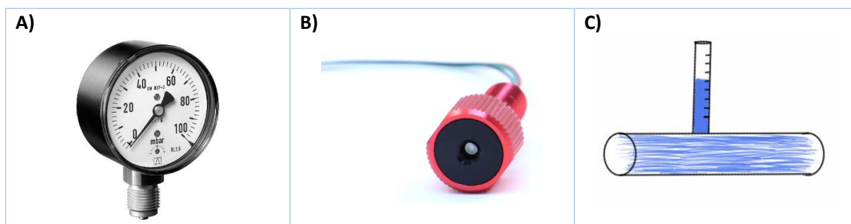
Figur 6-9. A) Måling av trykk ve hjelp av et manometer [60]. B) Måling av trykk ved hjelp av en elektronisk trykksensor [61]. C) Måling av trykk ved hjelp av en vannsøyle.
