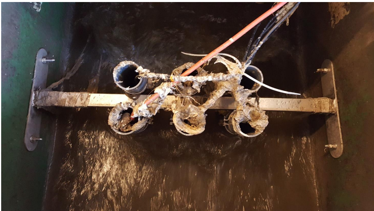
Figur 5-1 Nedføringsrør med sensorer etter nedbør. Foto: Andreas Lindhjem
