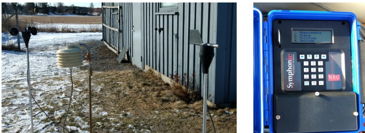
Figur 24: Anemometer, temperaturmåler, vindretningsmåler og NRG Symphonie-logger.
