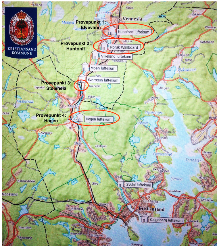
Figur 2.1: Bilde fra kommunens driftskontrollsystem, med oversikt over luftekummer og påslipp til Otraledningen. Vann ble hentet fra fire prøvepunkter, markert i kartet som prøvepunkt 1-4. Tilhørende sted/navn tilknyttet ledningen er i rød sirkel til høyre for hvert prøvepunkt. Prøvepunktet fra Støleheia er markert cirka ved påslippet til Otraledningen. Selve vannprøven ble imidlertid hentet ved utslippet fra anlegget. Utslipet til Kristiansandsfjorden er i Østerhavn, ved Galgeberg luftekum.
