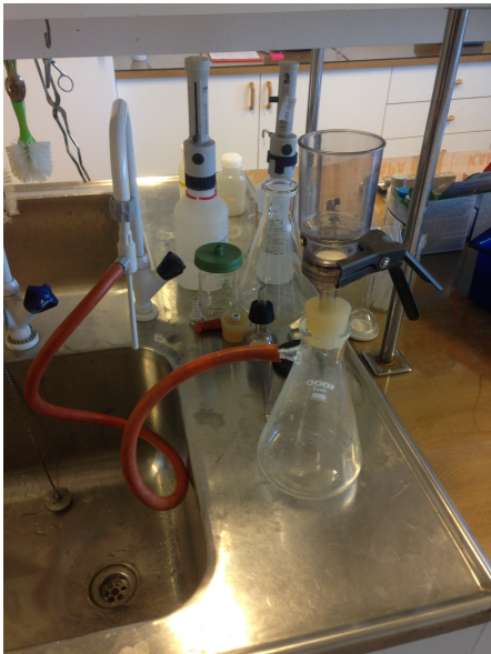
Figur 2.2: Vakuumpoppsett til filtrering av suspendert stoff (SS).
