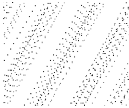
Figur 6.2: Utsnitt av Optech Titans faktiske punktfordeling. Fra LAsTools.
