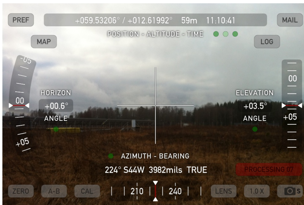
Figur 2.13: Skjermdump fra bruk av programmet Theodolite. Her vises plasseringen av markøren på horisonten. Dette punktet har høyde-vinkel på 3.5^\circ og azimuth-vinkel på 224^\circ (dette tilsvarer en azimuth-vinkel i PVsyst på 44^\circ ).
