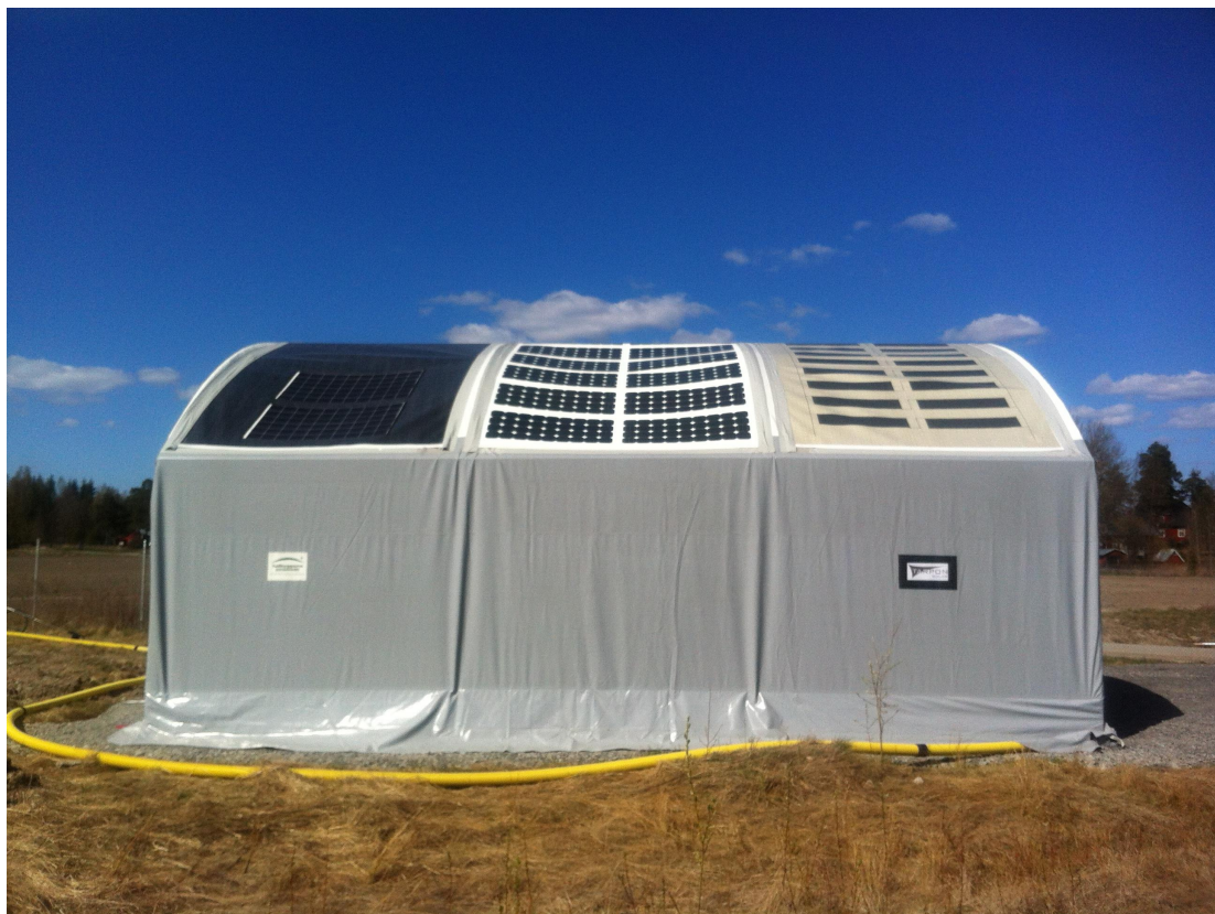
Figur 4.1: Oversikt over prototypen som ble bygget i Glava, Sverige. Til venstre vises c-Si-modulene, CIGS-modulene i midten og organiske moduler til høyre.
