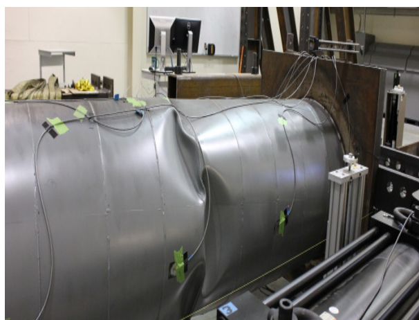
Figur 2-3: Lokal knekking av sylinderskall i testbenk [11].
