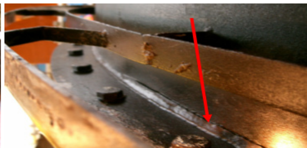
Figur 2-10: Sprekk ved flenset forbindelse [20].
