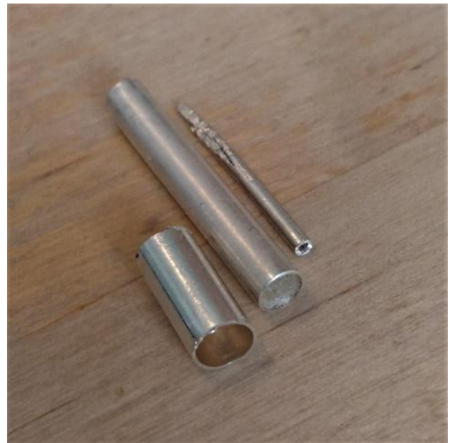
FIGUR 90: DE ULIKE DIMENSJONENE SØLVRØR: VENSTRE 5,3/4,7 MM. MIDT 4,3/3,8MM. HØYRE 1,5/0,7 MED MER [EGET FOTO].
