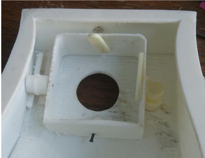
FIGUR 105: SKALL MED MONTERT FORLENGESES- OG ROTASJONSMEKANISME FØR MONTERING AV DEFLEKSJONSBØYLER, STYRESTAG OG DEFLEKSJONSKULE [EGET FOTO].
