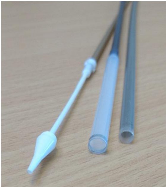
FIGUR 89: DISTALENDEN AV PLASTRØRENE FRA COREVALVE KATETER. DET MIDTRE RØRET HAR DIAMETER 6,0/5,35 MED MER [EGET FOTO].
