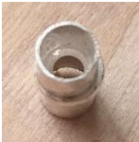
FIGUR 102: MELLOMSTYKKET SETT FRA DISTAL SIDE, HER VISES INNVENDIG HULL TIL DEFLEKSJONSWIRE [EGET FOTO].
