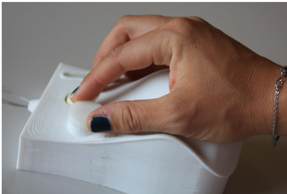
FIGUR 113: FUNKSJONSMODELL AV STYREENHET I BRUK. HER TESTES ROTASJONSKNAPPEN[EGET FOTO].
