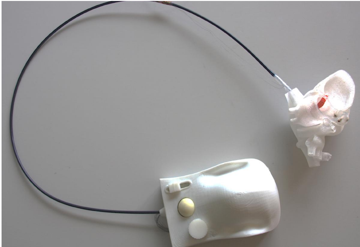
FIGUR 112: FUNKSJONSMODELL AV STYREENHET MED KATETERSLANGE DER DISTALENDEN ER Plassert gjennom mitralklaff inni hjertemodell [EGET FOTO].
