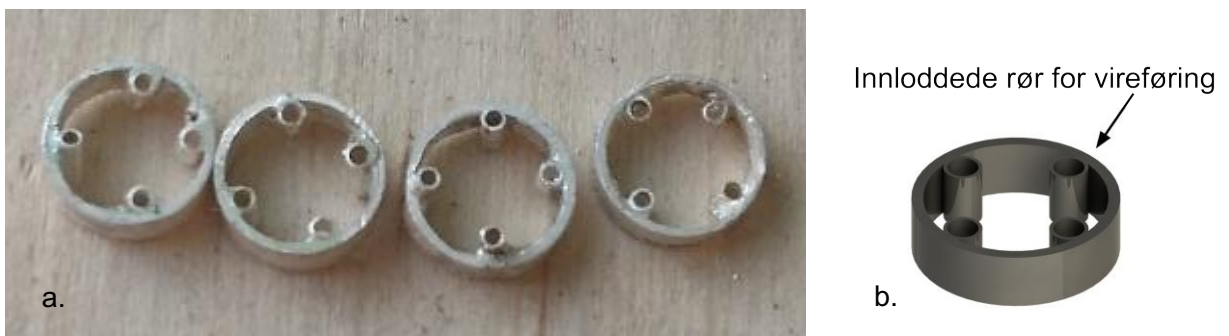
FIGUR 96: 2. VERSJON DEFLEKSJONSSARGER. A) FAKTISK DELER AVBILDET [EGET FOTO]. B) RENDERT DEL FRA SOLIDWORKS.
