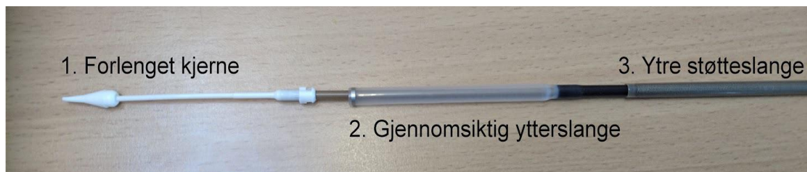
FIGUR 15: KATETERSLANGEN FRA COREVALVE HJERTEKATETER. FIGUREN BRUKES SOM REFERANSE TIL TEKSTEN "FUNKSJONSANALYSE AV COREVALVE HJERTEKATETER"[EGET FOTO].
