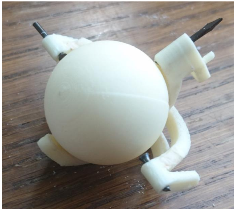
FIGUR 106: DEFLEKSJONSKULE, STYRESTAG, BØYLER OG INNFESTINGSBOLTER FØR MONTERING I SKALLET [EGET FOTO].
