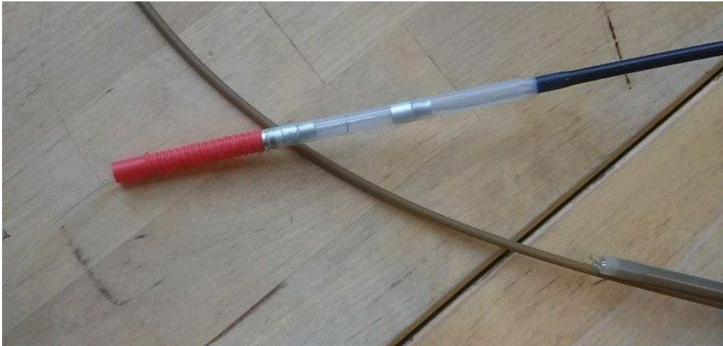
FIGUR 103: FØRSTE SAMMENSTILLING AV DISTALENDEN TIL KATETERET [EGET FOTO].
