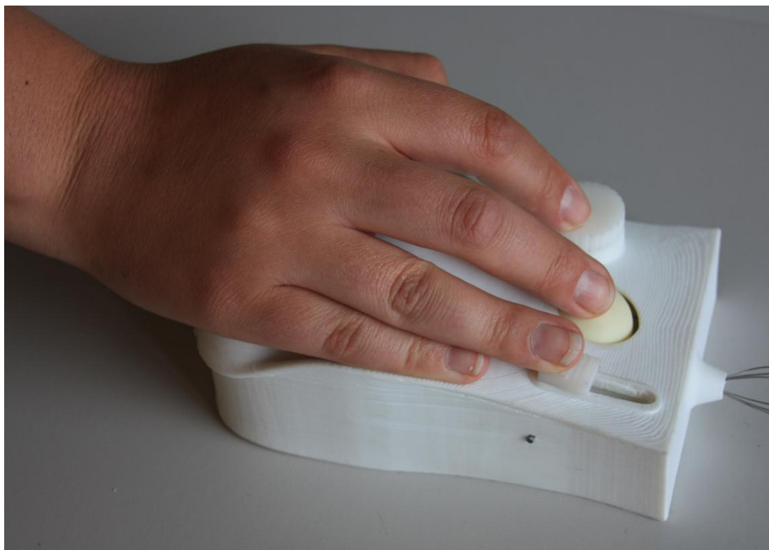
FIGUR 114: FUNKSJONSMODELL AV STYREENHET I BRUK. STYREENHETEN FRA HØYRE SIDE VISER STØTTEN FOR YTTERSIDE AV HÅND [EGET FOTO].
