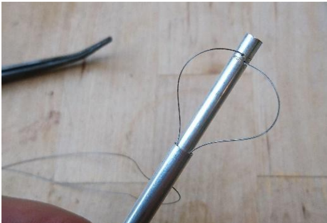
FIGUR 92: VIEREN FØRES FRA INNERRØRET OG UT GJENNOM YTERRØRET [EGET FOTO].
