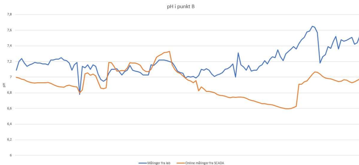
Figur 4-4: pH-målinger fra laboratoriemålinger og online fra SCADA for punkt B.
