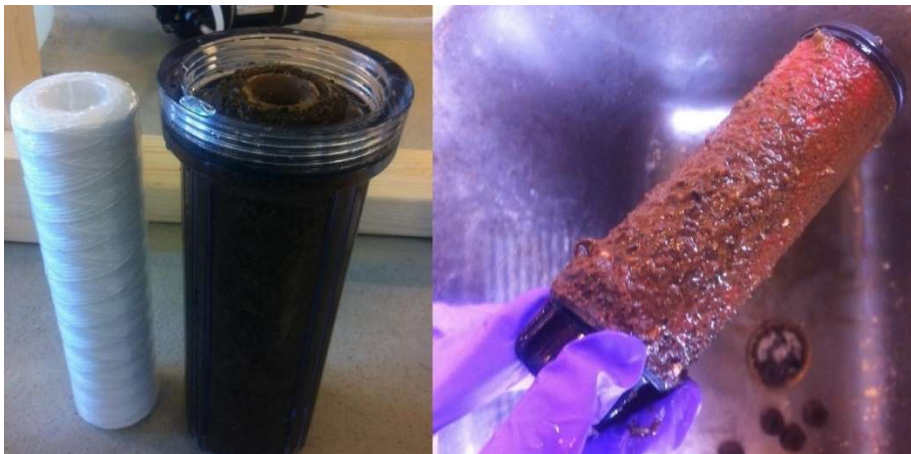
Figur 4-7: Til venstre er to filtre; et rent og et skittent mikrofilter (1 \mu\text{m} ) brukt i to døgn. Til høyre er et filter (130 mm) brukt i tre døgn (foto: H. D. Seip).
