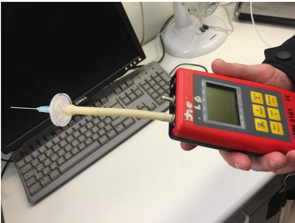
Figur 4.4 Digitalt manometer (GMH 3161 Greisinger Electronic, Germany). Foto: Ole Bendik Lilleby
