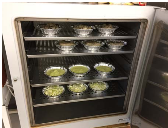
Figur 4.2 Tørkeskap. Prøvene tørkes på 105 °C i ca 24 timer. Foto: Ole Bendik Lilleby
