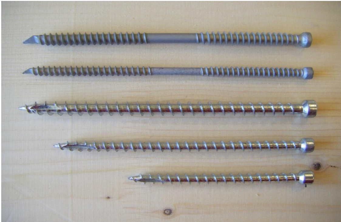
Figur 10 - Selvboende skruer brukt i tester. Fra topp til bunn: WT 8,2x160, WT 6,5x160, VGZ 9x160, VGZ 7x140, VGZ 7x100.
