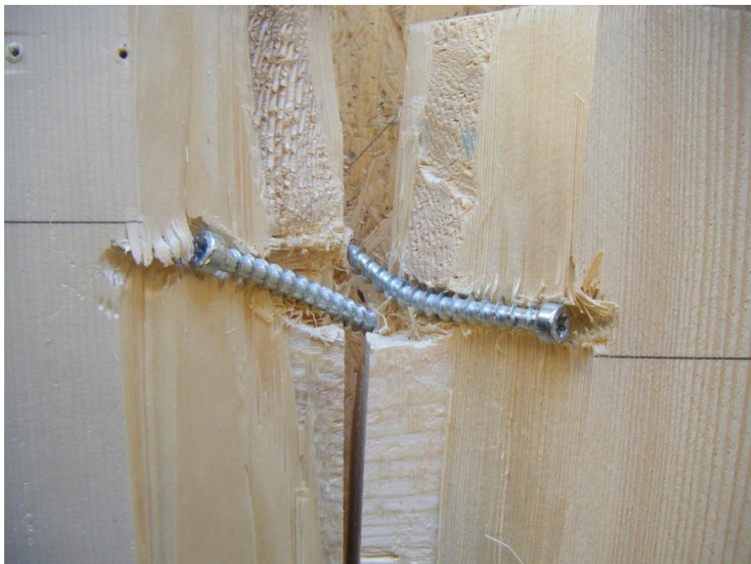
Figur 28 - En prøvene ble sagt opp for å se på detaljer etter deformasjon. Skruerforbindelse med skruetype VGZ 9x160. Skruene opplevde dobbel plastisk deformasjon.
