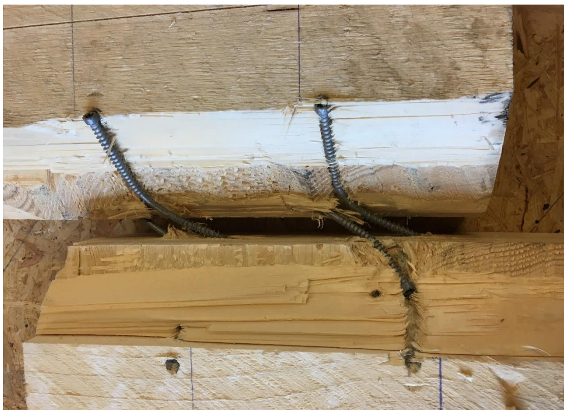
Figur 31 - Prøve WT8-1 sagt opp etter test viser flyteledd i skruene og gjennomtrekking av skruen i midterste element.
