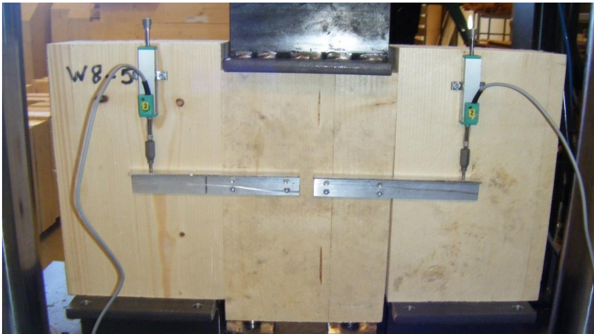
Figur 13 – Bilde av testoppsett med kraftcelle og forskyvningsmålere.
