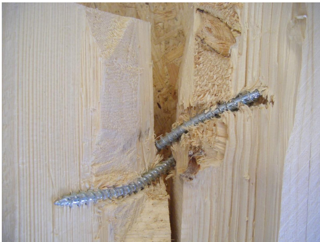
Figur 29 - Skruespissene på prøven som ble sagt opp.
