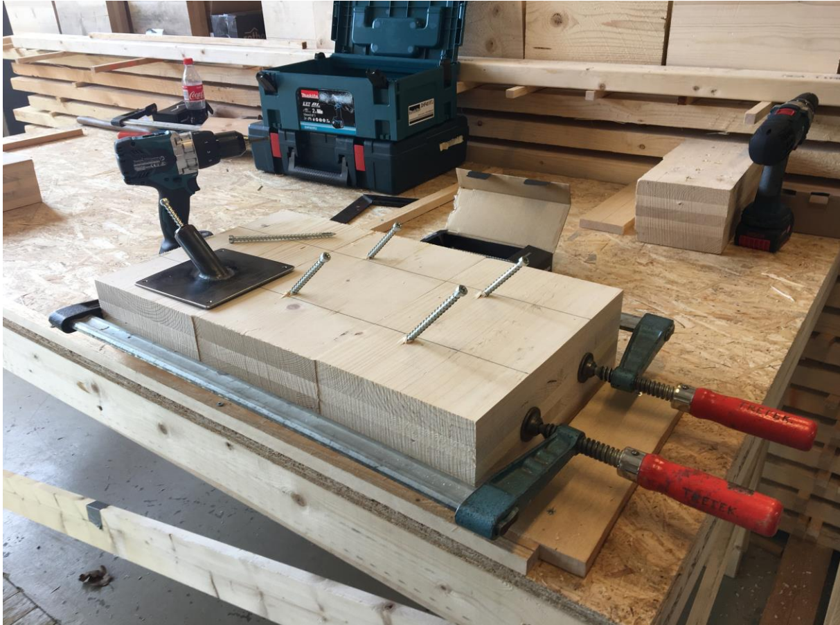
Figur 9 - Montering av prøve med VGZ 7x140-skruer og CLT-tykkelse på 120 mm. Alle skruene monteres med hånddrill, med et støtteapparat som gir høyere vinkelnøyaktighet.
