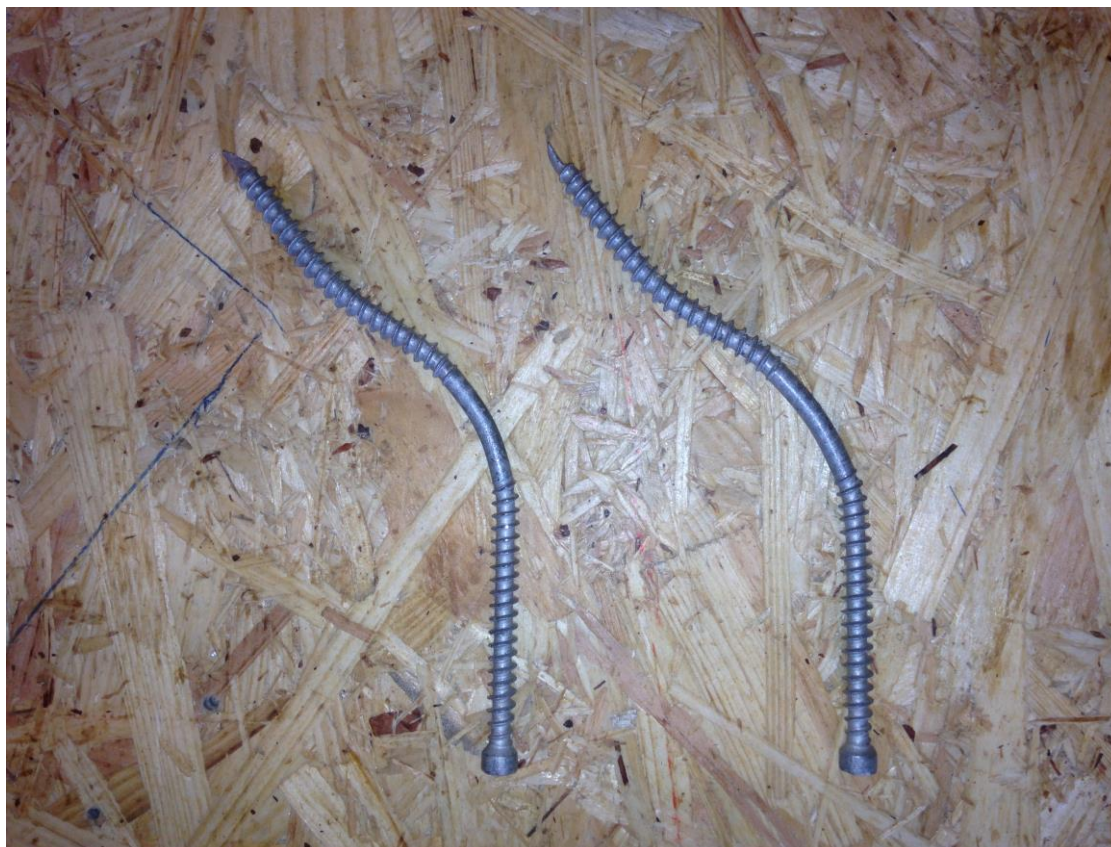
Figur 30 - To WT-skruer med dobbelt flyteledd (bruddform f) etter test.
