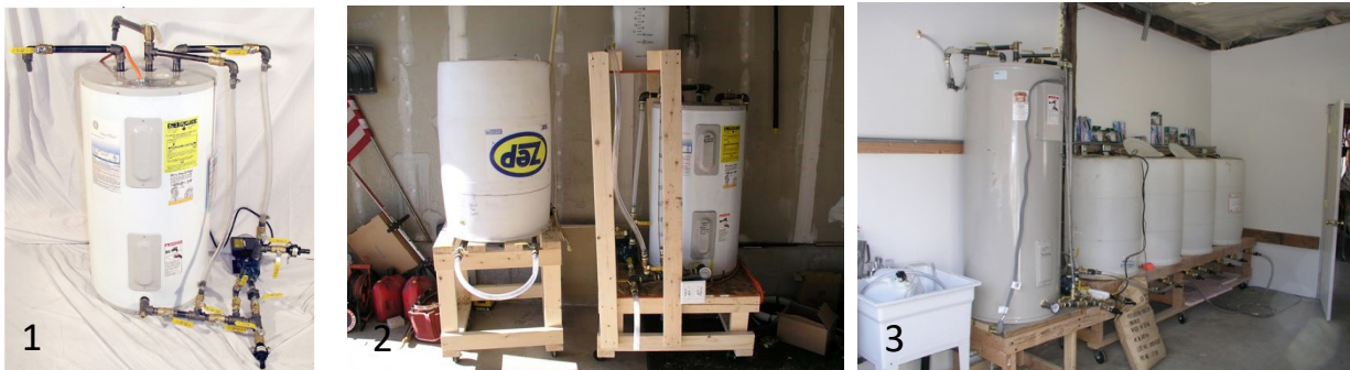
Figur 2-12: 1 : 114 l prosesstank, 4 000 NOK . 2 : 30 gallon prosesstank med 190 l vasketank 3 : 300 l prosesstank med 4 stk 210 l vasketanker. [4]
