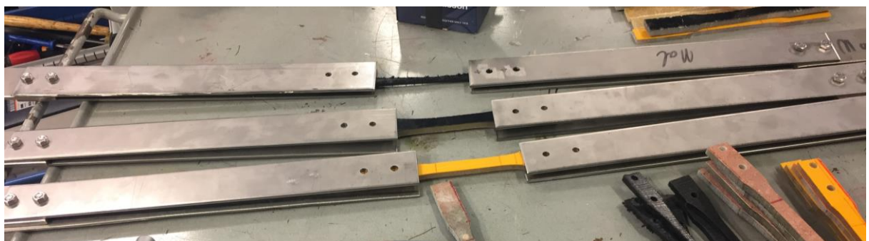
Figur 3-12 - Ferdig lagde og monterte skjøter som skal festes til prøvestykkene.
