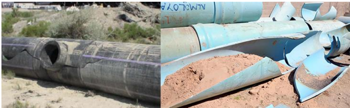
Figur 4-47 - Eksempler på sprekkevekst og brudd i plastrør på grunn av sprøhet og utmatting i plastmaterialet. [38] [39]
