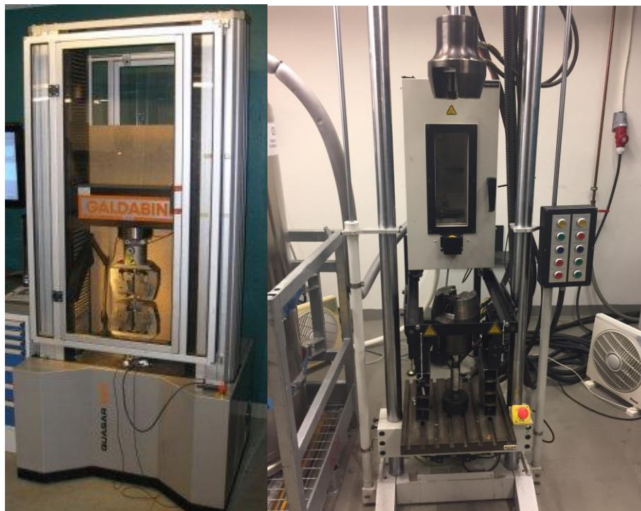
Figur 2-3 – Typiske strekkprøvemaskiner og et frysekammer som står på strekkprøvelaboratoriet ved Høgskolen i Oslo og Akershus. [16]
