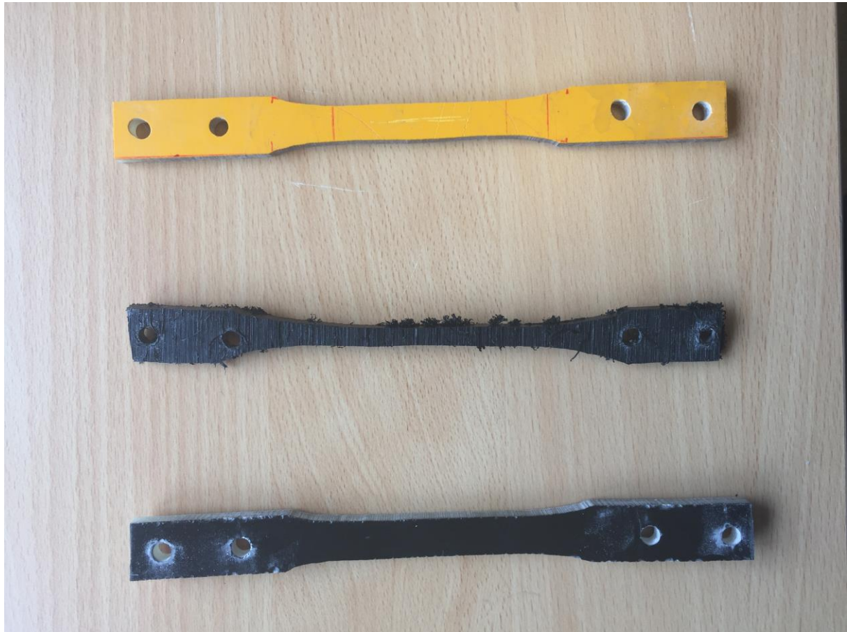
Figur 3-9 - Bearbeidede prøvestykker med borede hull slik at man kan feste de til skjøtene med bolter. Øverst og nederst: glassfiber. Midten: polyetylen (plast).
