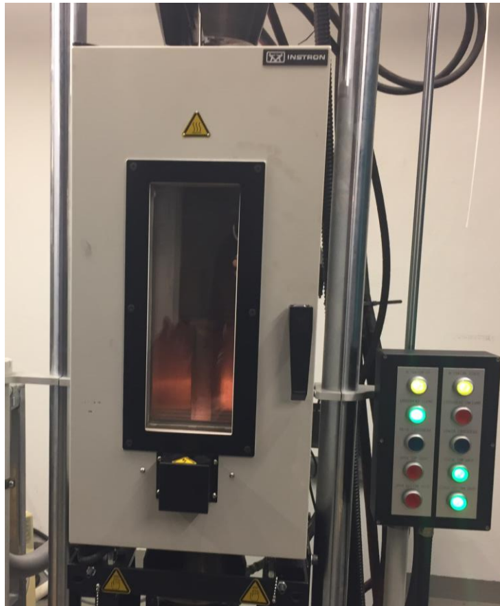
Figur 3-18 - Lukket frysekammer med prøvestykke fastmontert til skjøtene. Endene på skjøtene stikker ut av frysekammeret og er festet til prøvebakkene slik at det kan strekkes til prøvestykket går i brudd.
