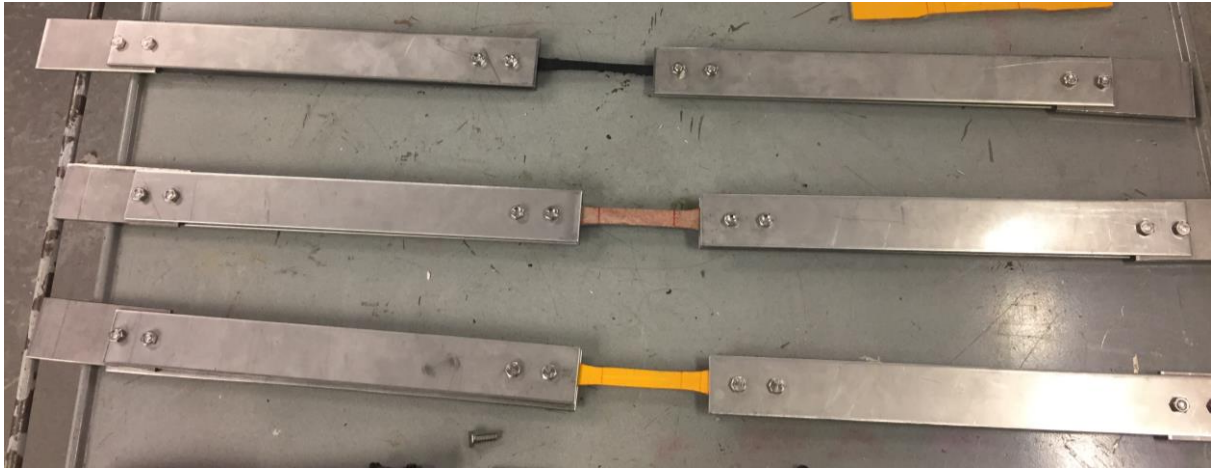
Figur 3-14 - Bilde av skjøtene ovenfra med fastmonterte prøvestykker etter det ble boret hull og festet med bolter.
