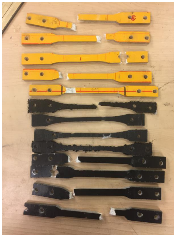
Figur 3-20 - Ødelagte prøvestykker som har blitt strukket til de har gått i brudd.
