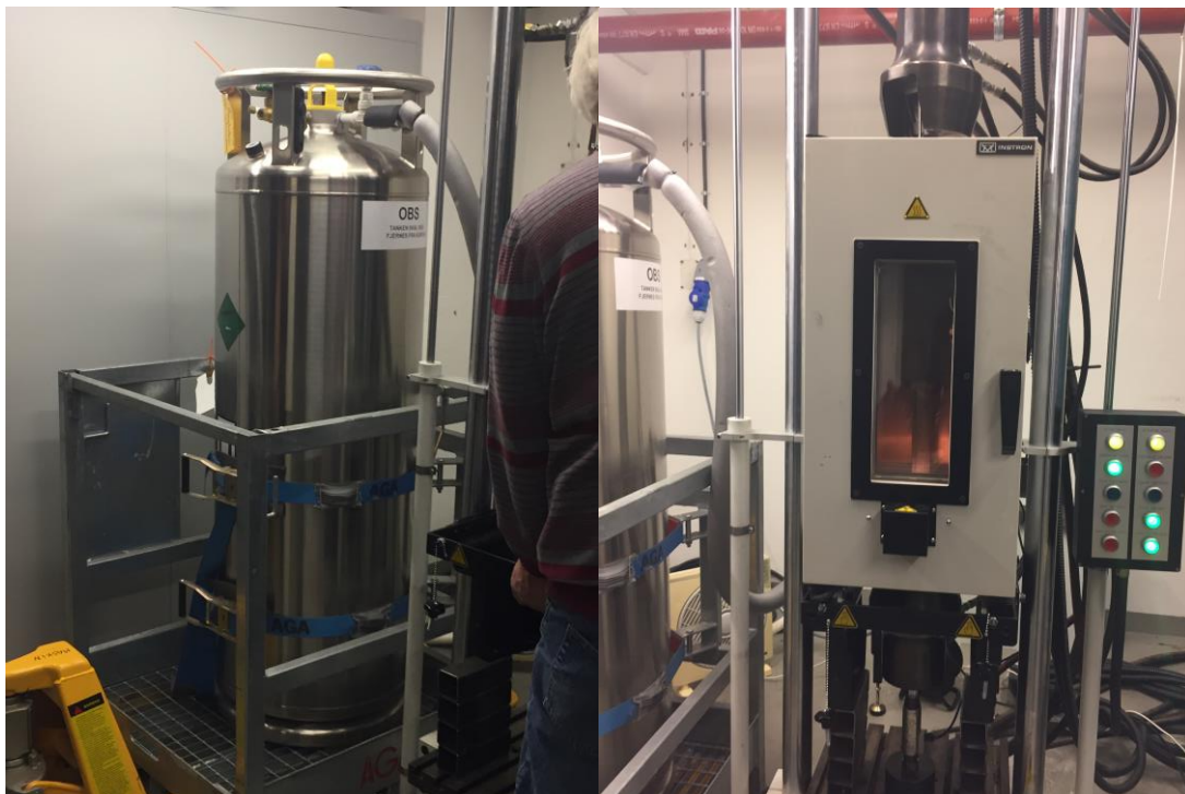
Figur 3-3 - Trykktank med flytende nitrogen og frysekammer på strekkprøvelaboratoriet ved Høgskolen i Oslo og Akershus.
