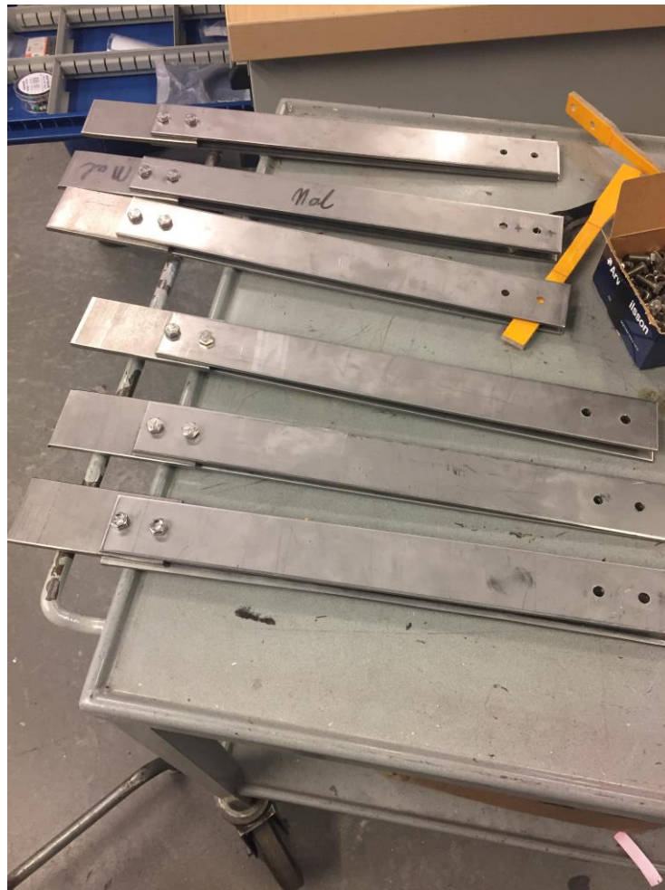
Figur 3-11 - Ferdig lagde og monterte skjøter som skal festes til prøvestykkene.
