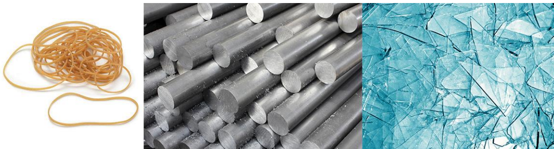
Figur 2-2 - Forskjellige typer materialer med forskjellige materialegenskaper. Fra venstre: gummistrikk, stål og glass. [3] [4] [5]
