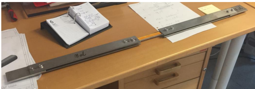
Figur 3-8 - Bilde som viser skjøtene og prøvestykket etter det er boret hull og festet med bolter.
