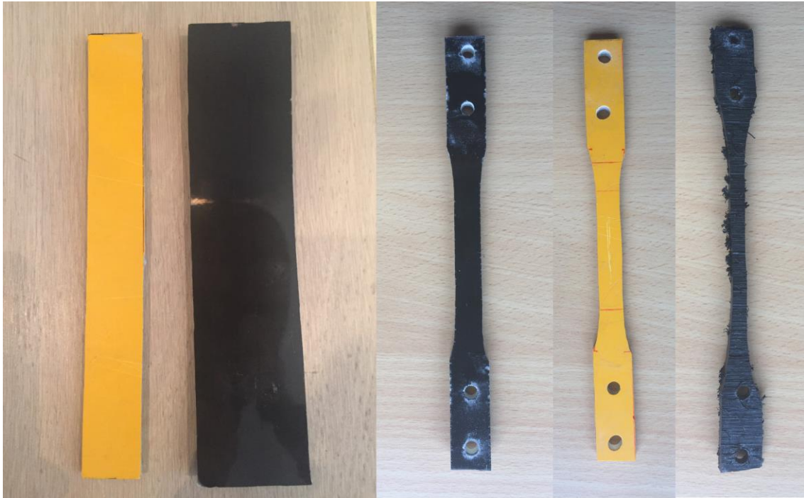
Figur 3-10 - Bilde som viser de opprinnelige glassfiberprøvene og de bearbeidede prøvestykkene av glassfiber og polyetylen.
