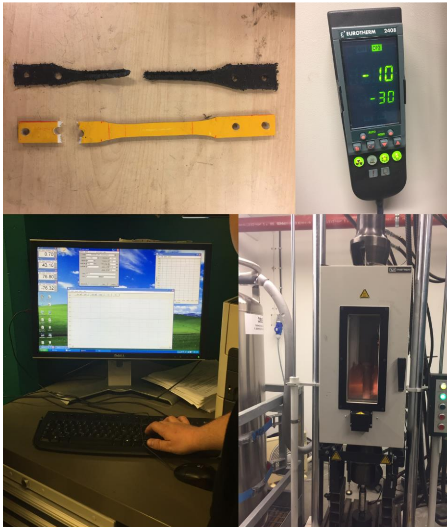
Figur 3-29 – Komponenter og utstyr som kan virke som feilkilder og bidra til unøyaktige målinger og resultater når man utfører strekktester.
