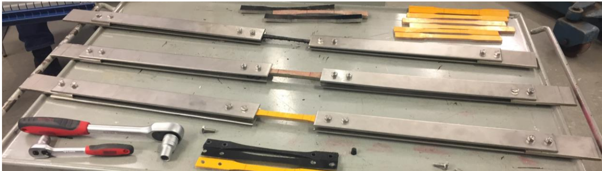
Figur 3-15 - Bilde av skjøtene fra siden med fastmonterte prøvestykker etter det ble boret hull og festet med bolter.
